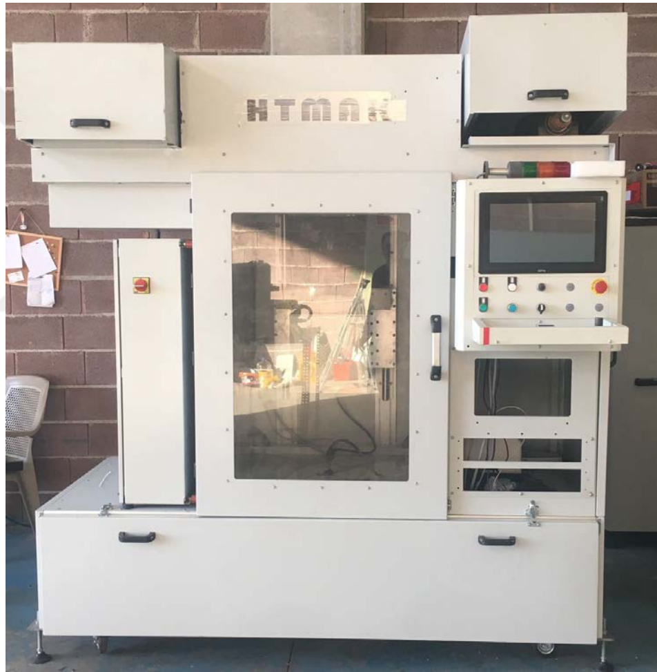
Şekil 2.6 Santrifüj elektro lif çekim sistemi prototipi
