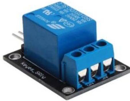
Şekil 3.9. 5V Mini Röle (5V 2A)
