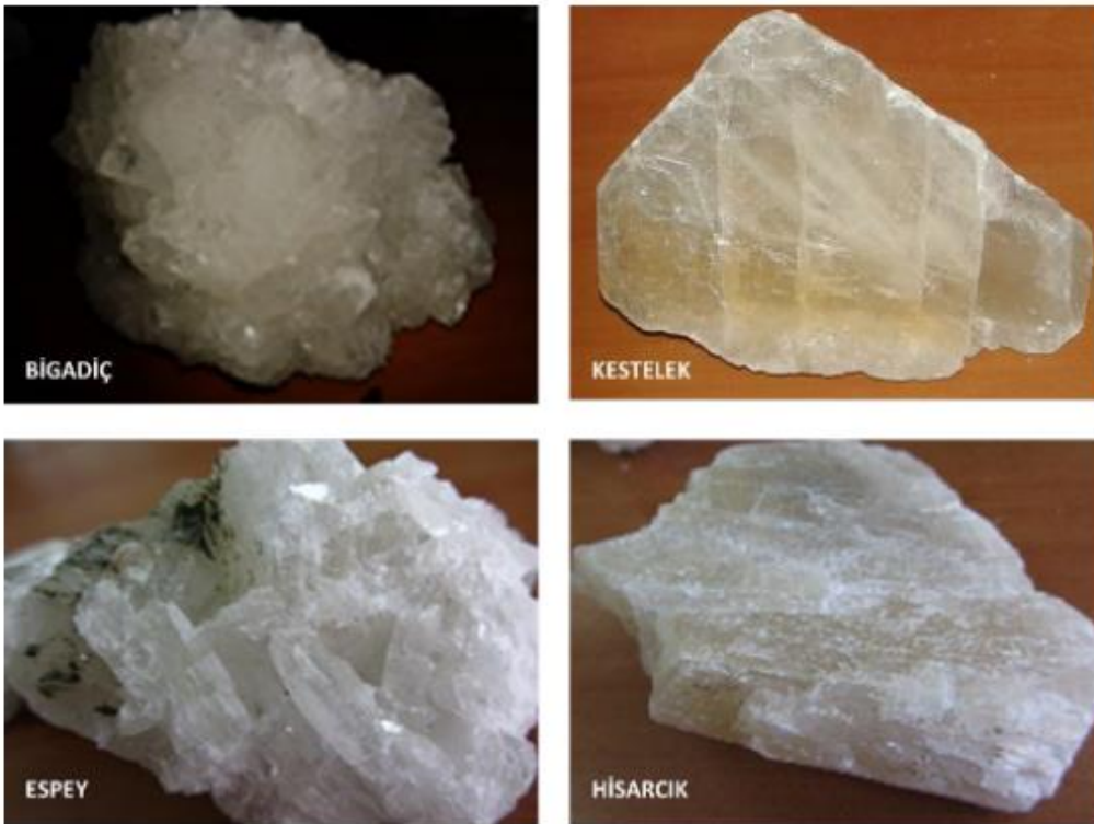
Şekil 2.5. Bigadiç, Kestelek, Espey ve Hisarcık yörelerinden temin edilen kolemanit kristalleri
