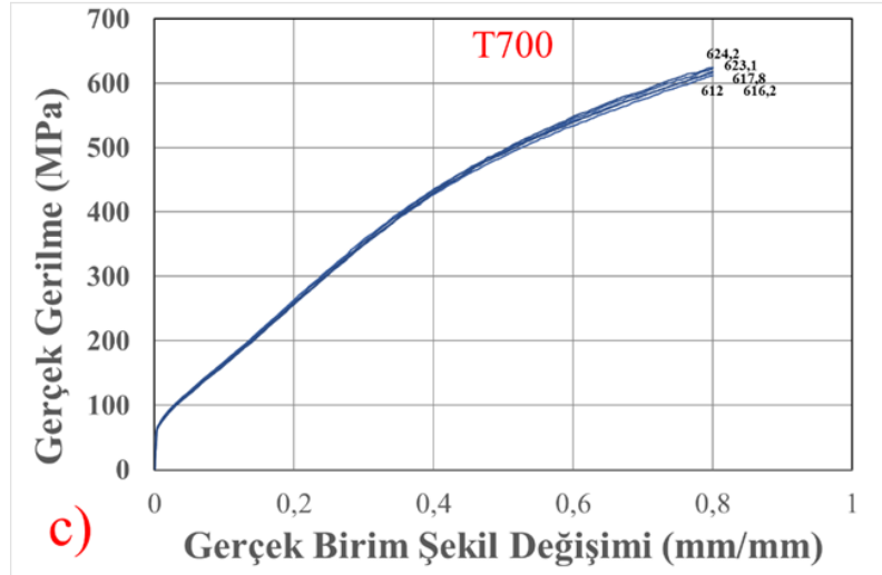
Şekil 3.15. 3.2 mm kare kesit kenar uzunluğuna sahip ve a) tane boyutu 43 \mu\text{m} (500°C’de tavllanmış), b) tane boyutu 100,2 \mu\text{m} (650°C’de tavllanmış), c) tane boyutu 205,8 \mu\text{m} (700°C’de tavllanmış) olan numunelerle gerçekleştirilen basma deneyleri sonucu elde edilen gerçek gerilme- gerçek birim şekil değişimi eğrileri.
