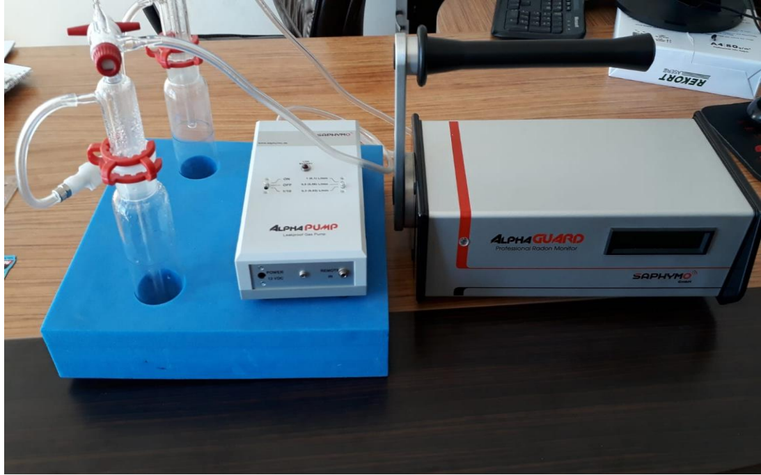
Fotoğraf 3.1 AquaKIT aksesuarı ile birlikte AlphaGuard radon monitörü
