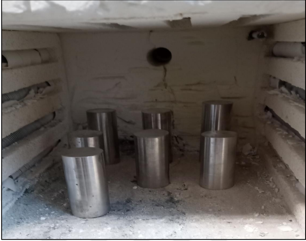
Şekil 3.6. Sıcak ekstrüzyon öncesi biyetlerin fırında ön ısıtması.
