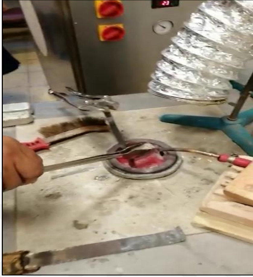
b) pota içinde ergitme işlemi
