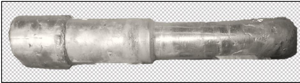
Şekil 3.4. Kalıptan çıkan döküm parça.
