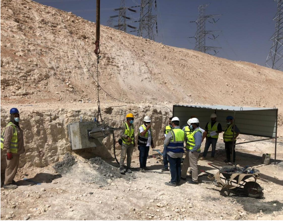
Şekil 3.16 Ankraj kabul testi genel görünümü.
