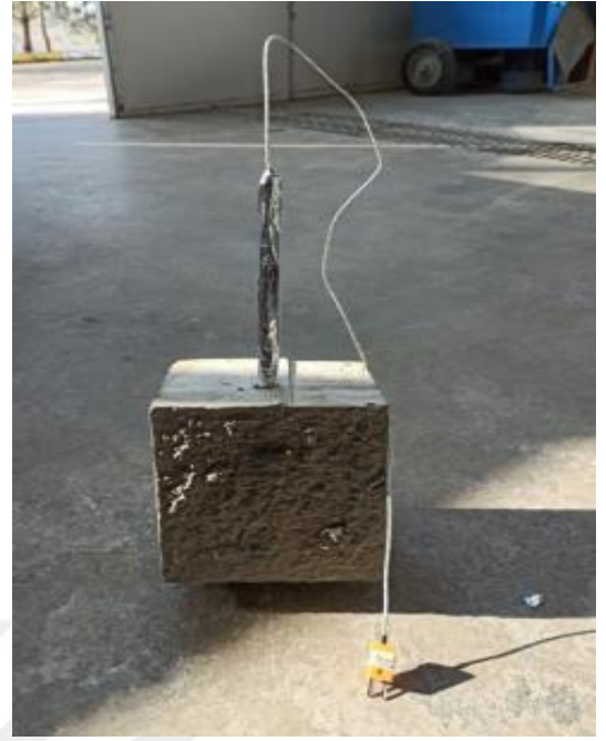
Şekil 3.22: Numunenin folyolu bant ile sarılması ve propun yerleştirilmesi.
