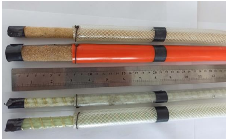
Şekil 3.14: GFRP donatıların borular ile sarılıp kenetlenme yerlerinin belirlenmesi.
