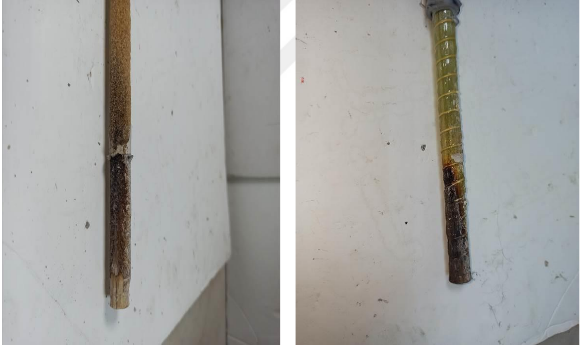
Şekil 4.14: GFRP donatıların sıcaklık altında kararma yapması.
