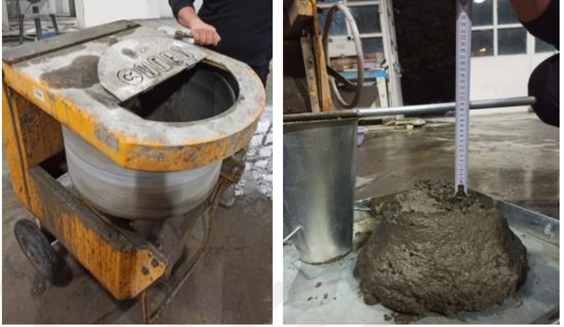
Şekil 3.16: Beton mikseri ve slump deneyi.
