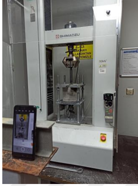
Şekil 3.11: Numunelerin çekme test düzeneği.
