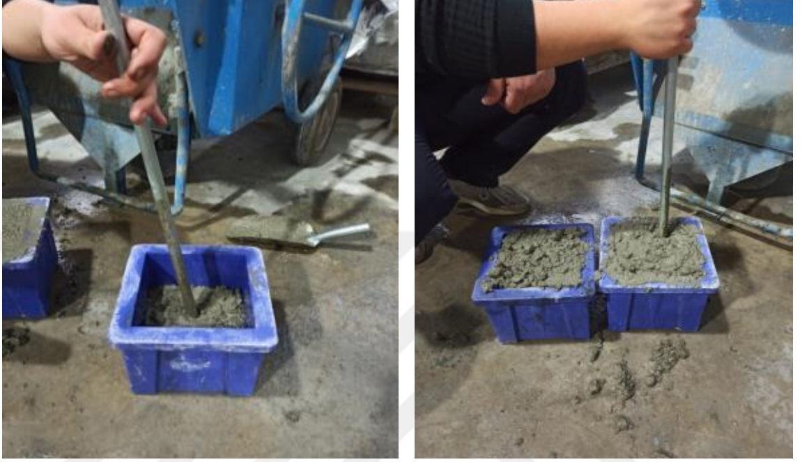
Şekil 3.18: Numunelerin 1. ve 2. tabakasının şişlenmesi.
