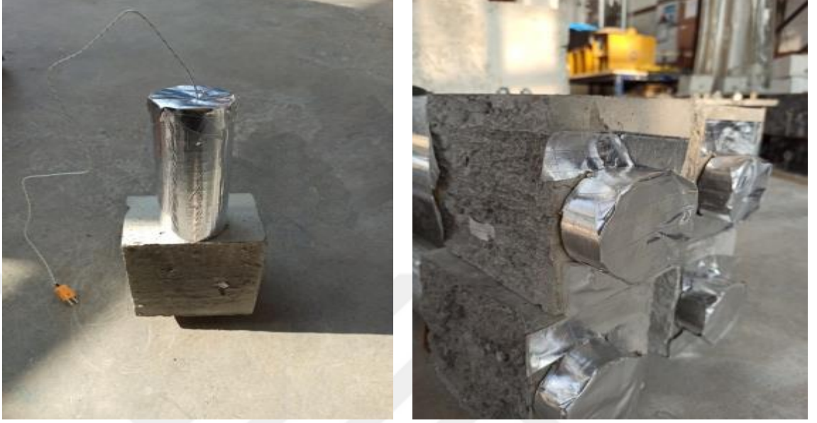
Şekil 3.24: Açıkta kalan donatının Prefabrik camyünü borular ile sarılması.
