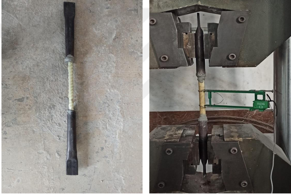
Şekil 3.3: GFRP donatıların çekme testi.
