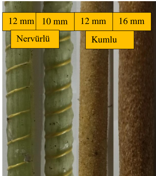
Şekil 3.1: Deneysel çalışmada kullanılan kumlu ve nervürlü GFRP donatılar.
