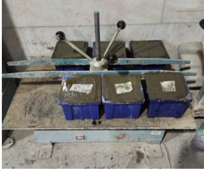
Şekil 3.19: Numunelerin titreşim sehpasında boşluk oranının düşürülmesi.
