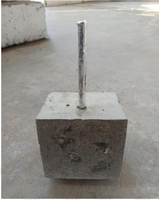
Şekil 3.22: Numunenin folyolu bant ile sarılması ve propun yerleştirilmesi.
