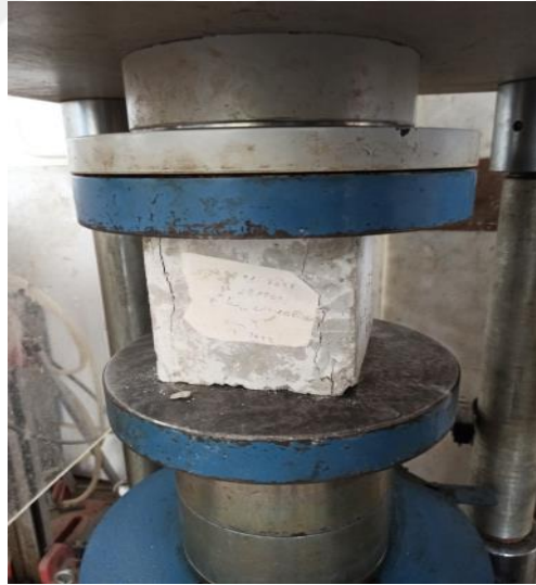
Şekil 3.6: Standart küp beton numune testi.
