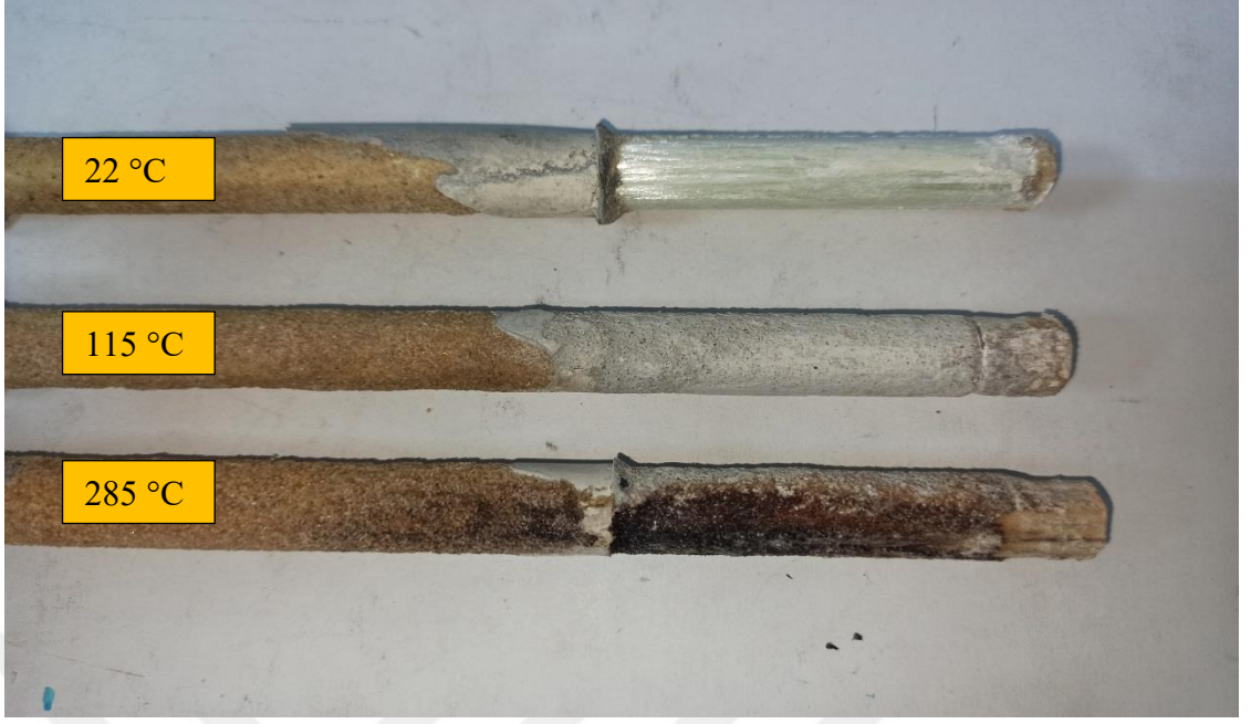
Şekil 4.13: Kumlu GFRP donatıların sıcaklık altındaki deformasyonları.
