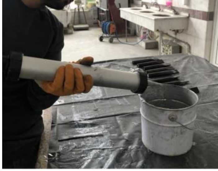
Şekil 3.29: Hazırlanan epoksinin sosis tabancası içerisine konulması.
