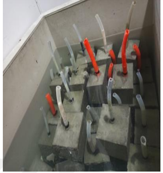
Şekil 3.21: Dökülen numunelerin kalıp içerisinden sökülmesi ve kür havuzunda bekletme.
