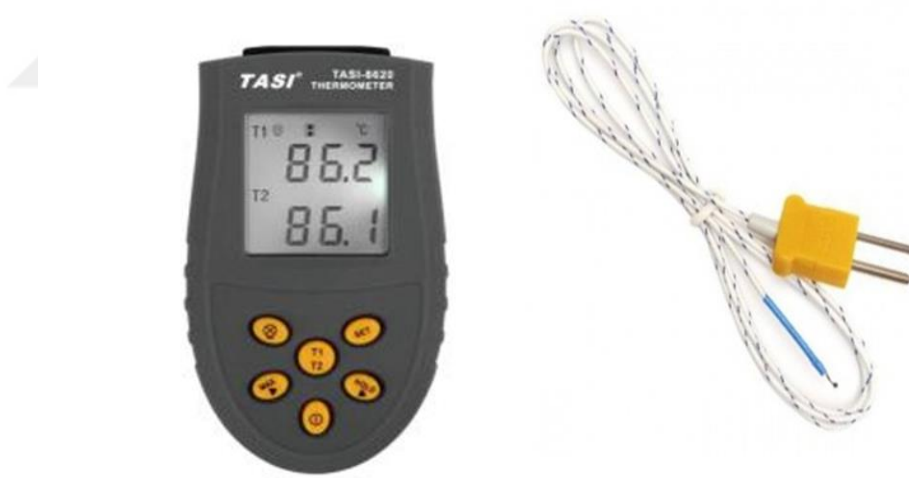
Şekil 3.7: K tipi çift girişli prop ve K tipi yüzey ve hava termokulpu [65-66].
