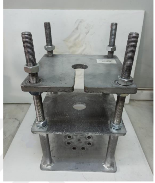
Şekil 3.10: Numunelerin test hazır şeması ve üretilen makine aparatı.
