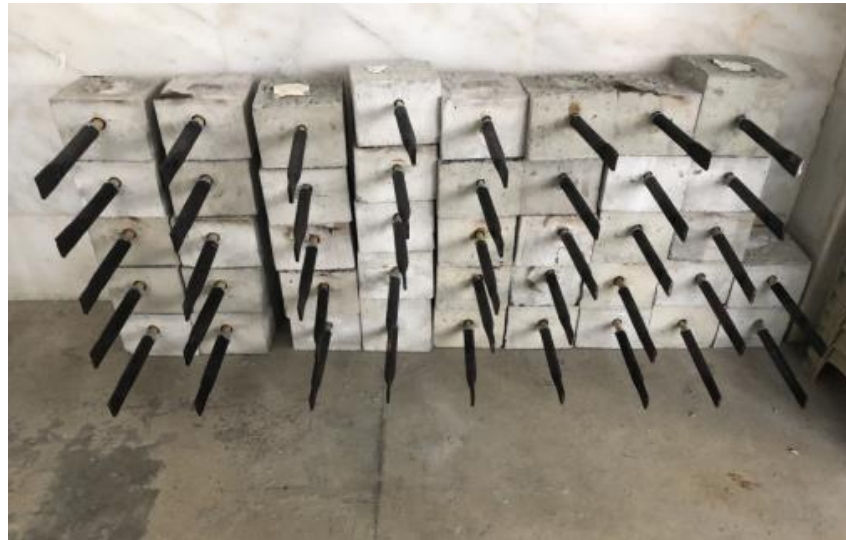
Şekil 3.32: Epoksinin kuruması için numunelerin oda sıcaklığında bekletilmesi.
