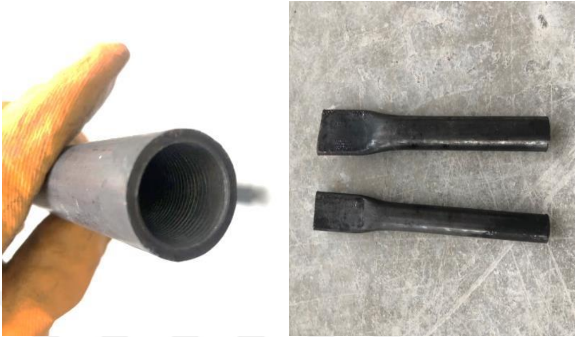
Şekil 3.27: Çekme deneyleri için hazırlanan çelik borular ve boru içine açılan diş.
