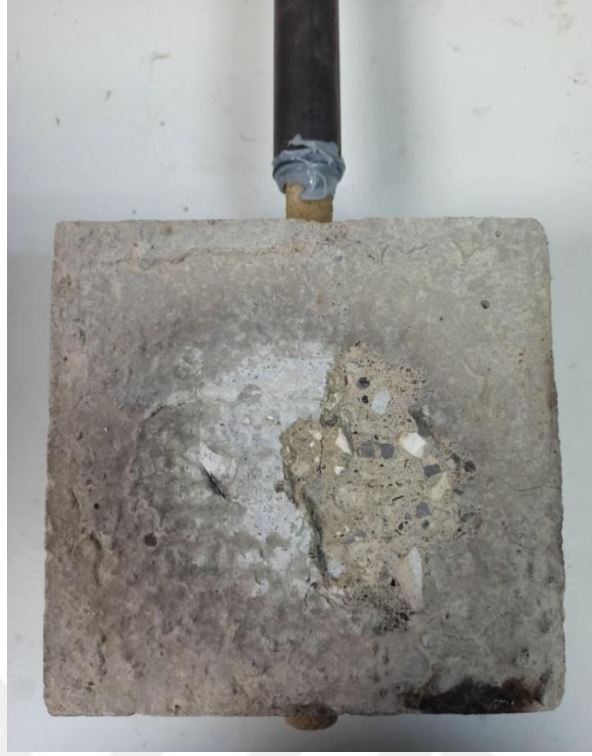
Şekil 4.11: Yüksek ve ani ısınmaya bağlı betonun kabuk atması.
