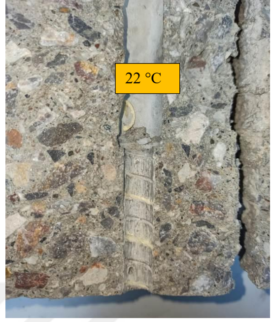
Şekil 4.15: Nervürlü GFRP donatının 22 °C ve 285 °C'de beton içinde davranışı.
