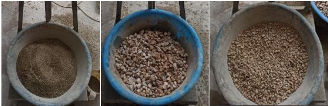
Şekil 3.4: Beton üretiminde kullanılan malzemeler (dere kumu ve mıcır).
