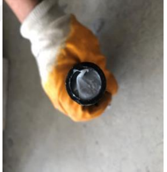
Şekil 3.30: Epoksinin çelik borular içine doldurulması.
