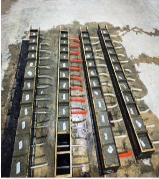
Şekil 3.21: Dökülen numunelerin kalıp içerisinden sökülmesi ve kür havuzunda bekletme.
