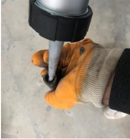
Şekil 3.30: Epoksinin çelik borular içine doldurulması.
