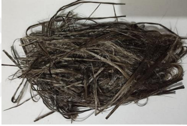
Şekil 3.2: Yanma sonucu elde edilen cam lifi.
