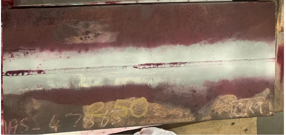
Şekil 4. 22 250°C ön ısı uygulaması ile kaynak yapılan test numunesinin kök bölgesinin sıvı penetrant testi
