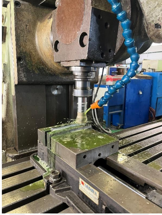
Şekil 4. 66 ITAB bölgesinden 16mmx16mm olarak kesilen çubukların bor yağlı freze tezgahında 13mmx13mm şekline getirilmesi
