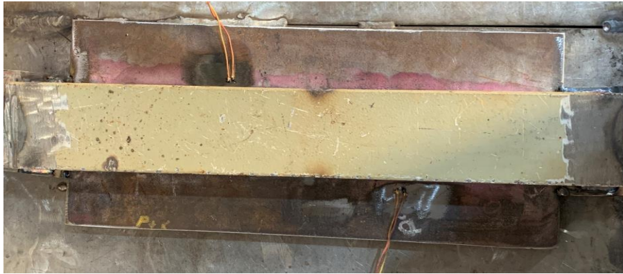
řekil 3. 20 Kk koruma gazı iin U profilden yapılan kanal ve ısıtıl işlem cihazının termokupol yerleřimi
