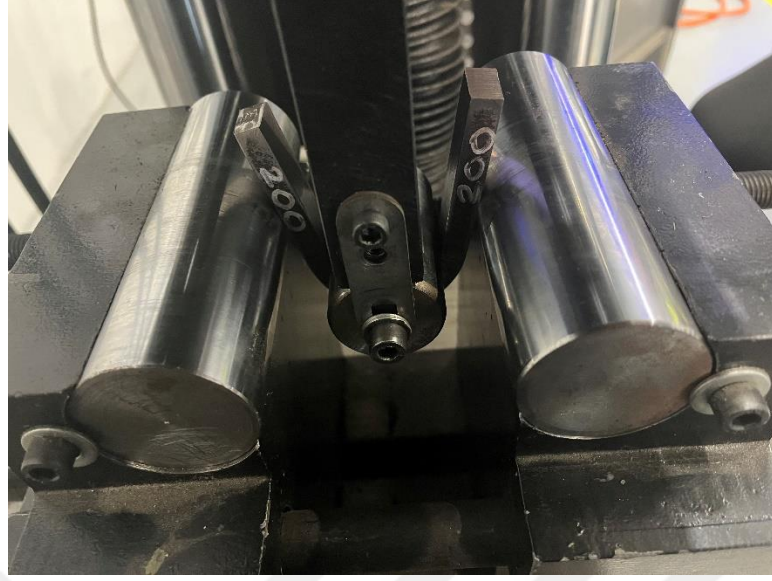
Şekil 4. 57 200°C ön ısı uygulanan kaynaklı numuneden enine kesit alınarak yapılan yan eğme deneyi görüntüsü
