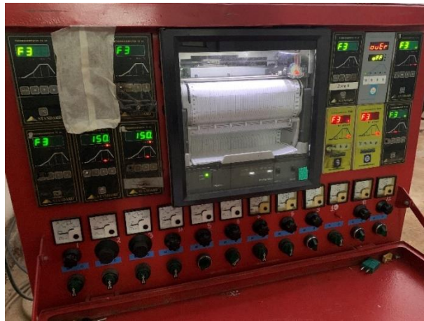
Şekil 3. 9 Ön ısı ve ısıtıl işlem için kullanılan Weldotherm 82 Kv 12 kanallı ısıtıl işlem makinası
