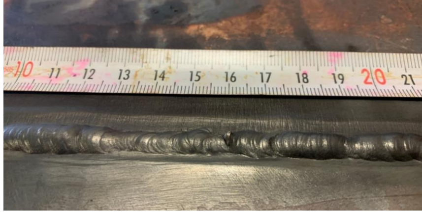
Şekil 4. 7 200°C ön ısı uygulaması ile kaynak yapılan test numunesinin kök kısmında 160-162mm aralığında tel kesiği
