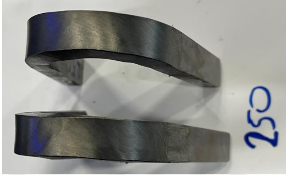
Şekil 4. 61 250°C ön ısı uygulanan kaynaklı numuneden enine kesit alınarak yapılan yan eğme deneyi sonucundaki görüntü
