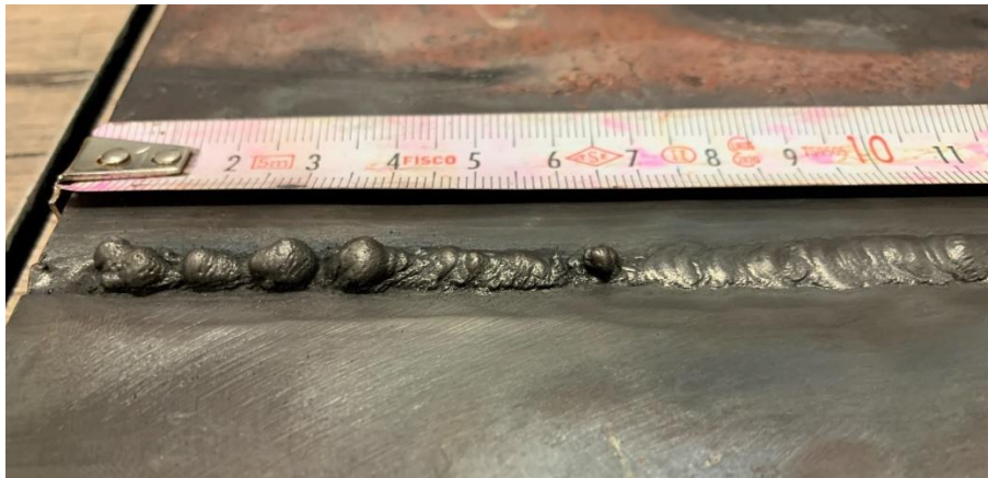
Şekil 4. 12 250°C ön ısı uygulaması ile kaynak yapılan test numunesinin kök kısmında 5-65mm aralığında kökte sarkma
