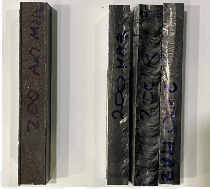
Şekil 4. 64 200°C ön ısı uygulanan kaynaklı plakada çıkartılan çekme çubukların konumları görülmektedir
