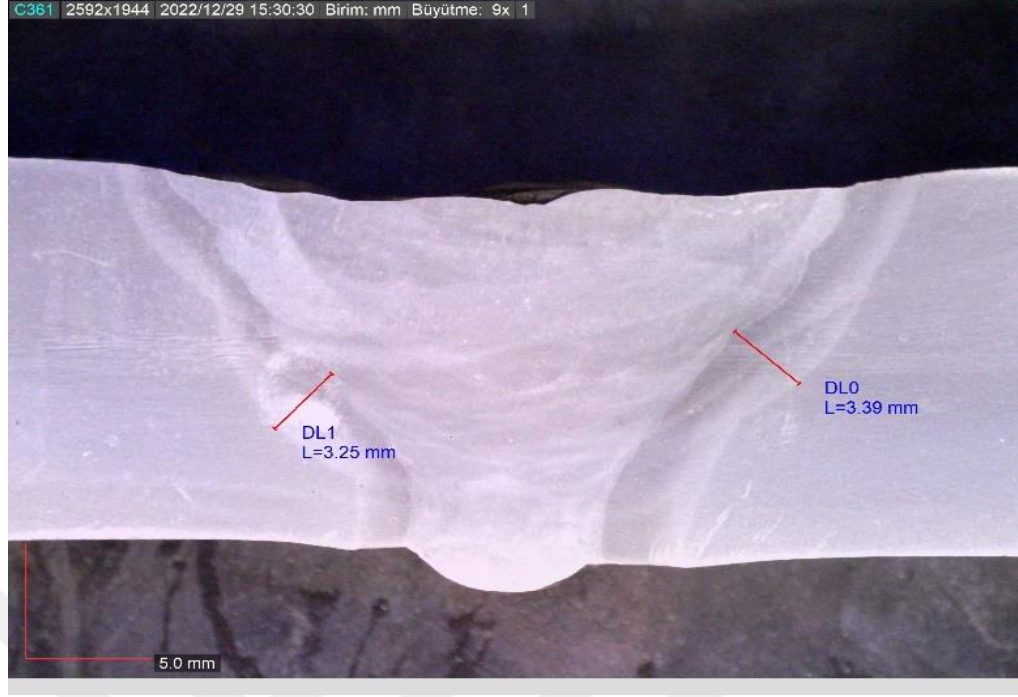
Şekil 4. 31 200°C ön ısı uygulaması ile kaynatılan numunede enine kesitin makroyapı incelemesi
