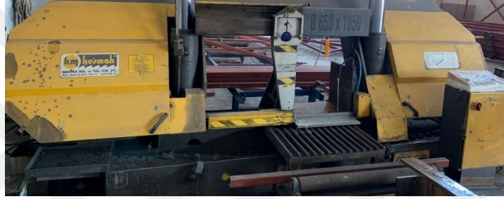
Şekil 3. 1 Plakaların şerit testere kullanılarak soğuk kesim yapıldığı esnada çekilmiş fotoğraf
