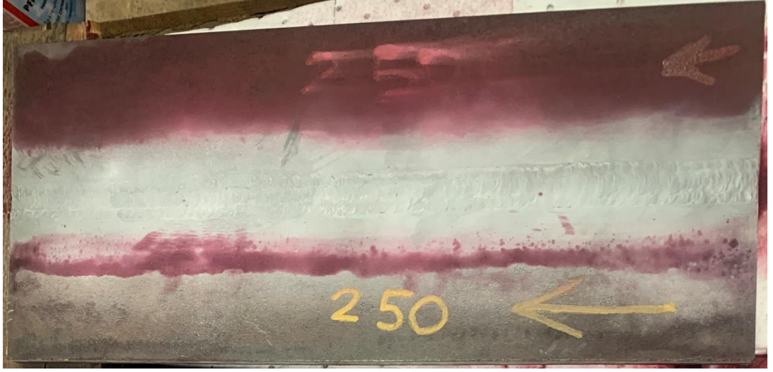
Şekil 4. 21 250°C ön ısı uygulaması ile kaynak yapılan test numunesinin kep bölgesinin sıvı penetrant testi
