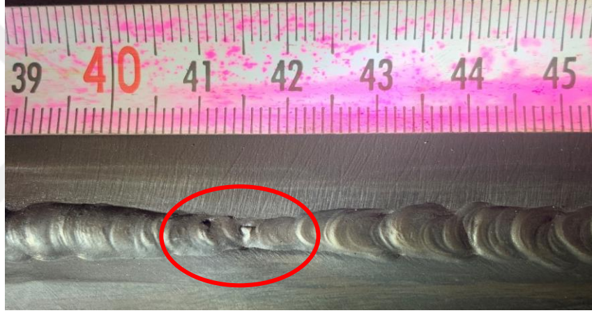
Şekil 4. 8 200°C ön ısı uygulaması ile kaynak yapılan test numunesinin kök kısmında 413-419mm aralığında yan cidar ergime noksanlığı
