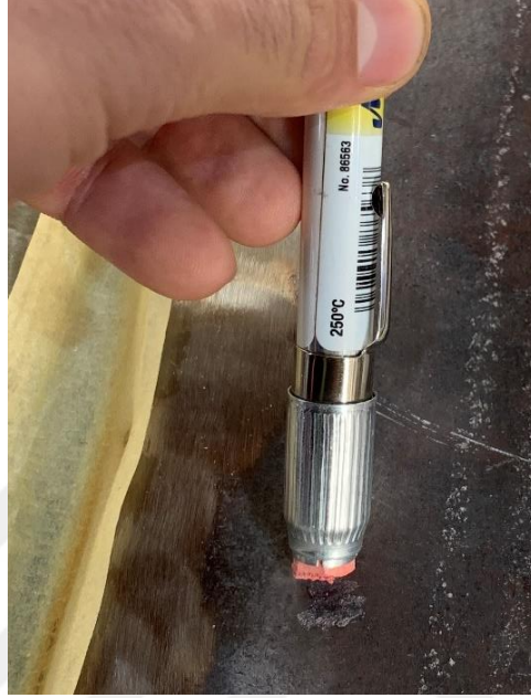
Şekil 3. 18 250°C ön ısı kontrollü kaynak sırasında 250C ısı tebeşiri ile malzeme sıcaklığının kontrolü sırasında çekilmiş fotoğraf
