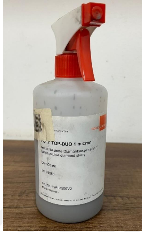
Şekil 4. 42 Parlatma işleminde kullanılan POLY-TOP-DUO 1micron elmas çözeltisi
