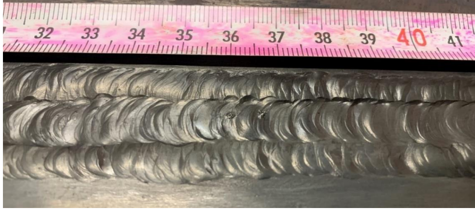
Şekil 4. 10 250°C ön ısı uygulaması ile kaynak yapılan test numunesinin kep kısmında 359-361mm ve 365-367mm aralığında tel kesigi
