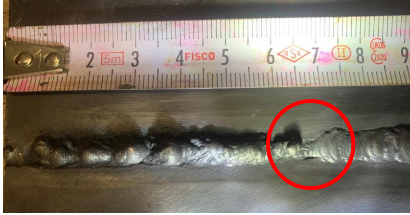
Şekil 4. 13 250°C ön ısı uygulaması ile kaynak yapılan test numunesinin kök kısmında 66-70mm aralığında yan cidar ergime noksanlığı
