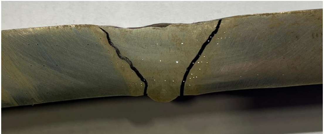
Şekil 4. 36 200°C ön ısı uygulaması ile kaynatılan plakada enine kesit üzerinden alınan sertlik ölçümlerinin izlerin görüldüğü fotoğraf
