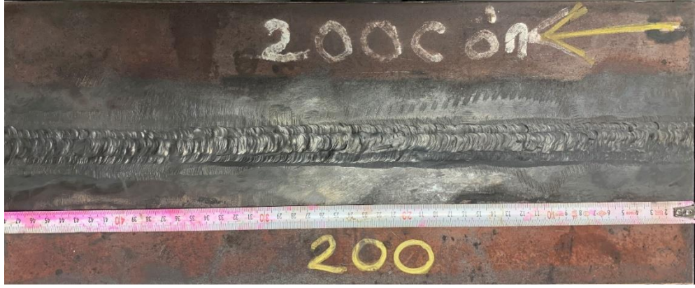
Şekil 4. 4 200°C ön ısı ile kaynak yapılan test numunesinin kep kısmından çekilen fotoğraf
