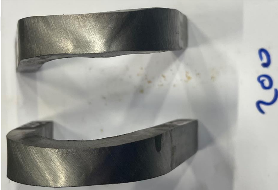
Şekil 4. 60 200°C ön ısı uygulanan kaynaklı numuneden enine kesit alınarak yapılan yan eğme deneyi sonucundaki görüntü
