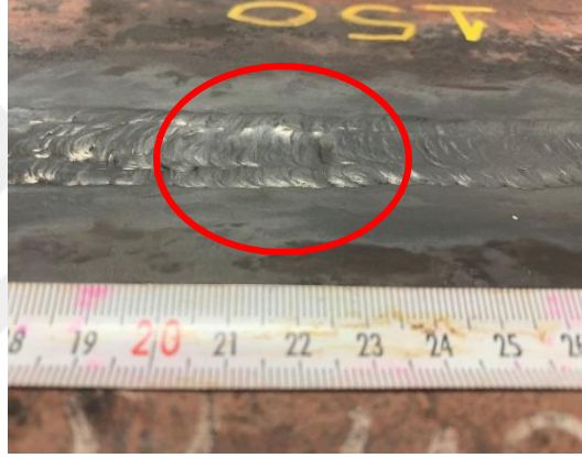
Şekil 4. 2 150°C ön ısı ile kaynak yapılan test numunesinin kep kısmında 200-225mm aralığında 1mm kaynak düşüklüğü
