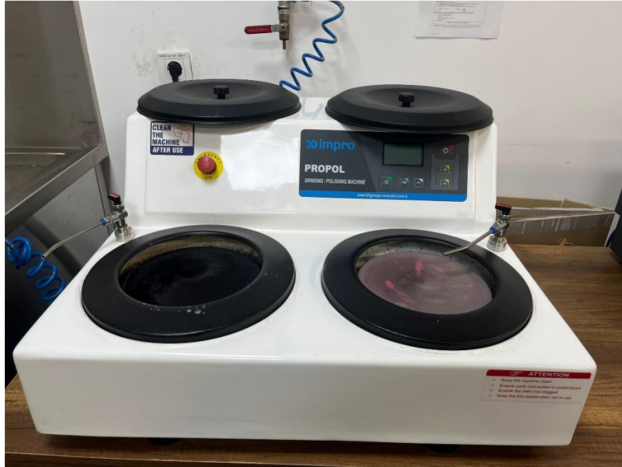
Şekil 4. 43 Zımparalama ve parlatma işleminde kullanılan impro PROPOL zımparalama ve parlatma makinası
