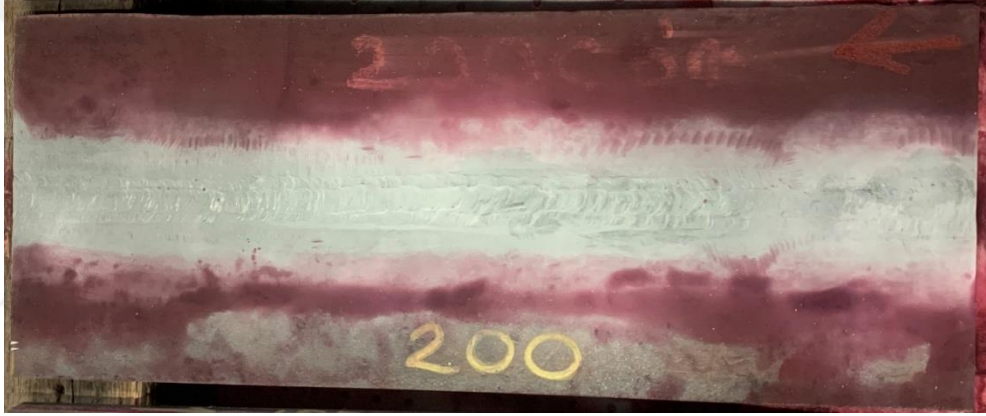
Şekil 4. 17 200°C ön ısı uygulaması ile kaynak yapılan test numunesinin kep bölgesinin sıvı penetrant testi
