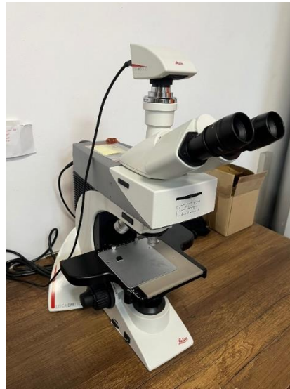
Şekil 4. 41 Metalografik incelemelerde kullanılan LEICA DM 2700M metalografi mikroskobu
