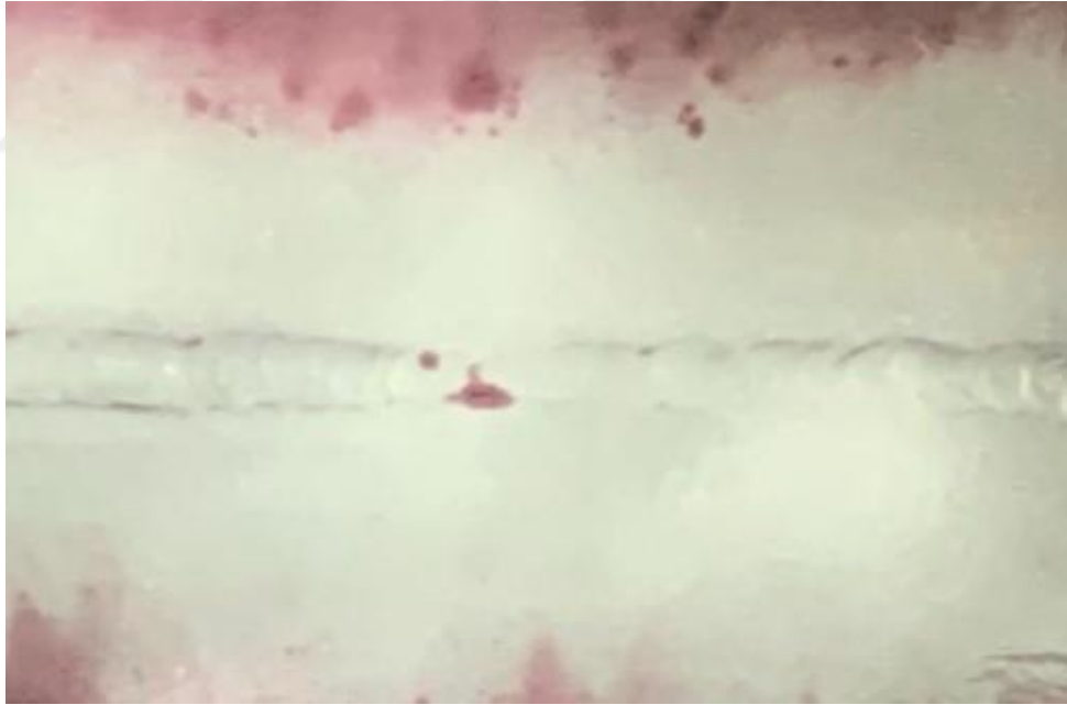
Şekil 4. 20 200°C ön ısı uygulaması ile kaynak yapılan test numunesinin kök kısmında 413-419mm aralığında ergime noksanlığının sıvı penetrant testi neticesinde belirtisi
