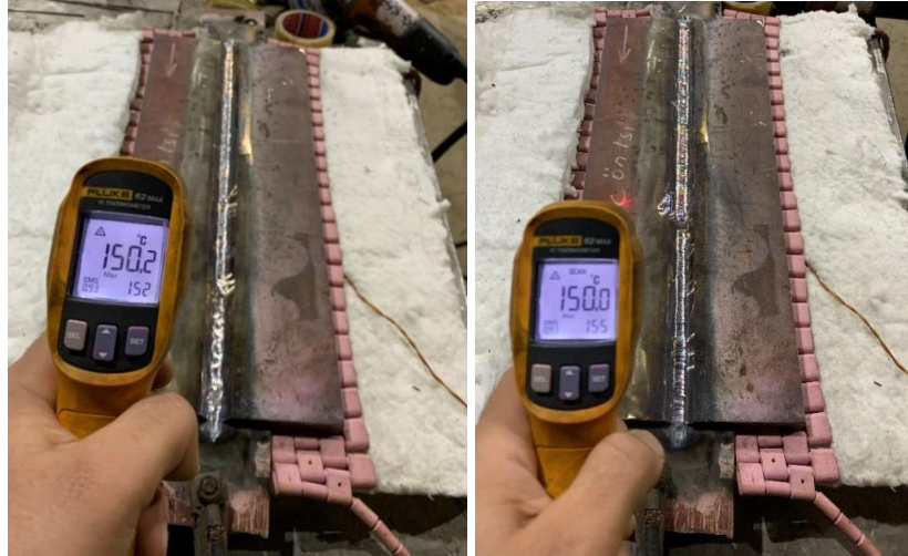
Şekil 3. 13 150°C ön ısı kontrollü kaynak sırasında lazerli sıcaklık ölçerle malzeme sıcaklığının kontrolleri sırasında çekilmiş fotoğraf
