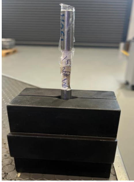
Şekil 4. 68 Hazırlanan çekme çubuğunun çekme test cihazı dairesel numune tutucu çenesi ile görüntüsü
