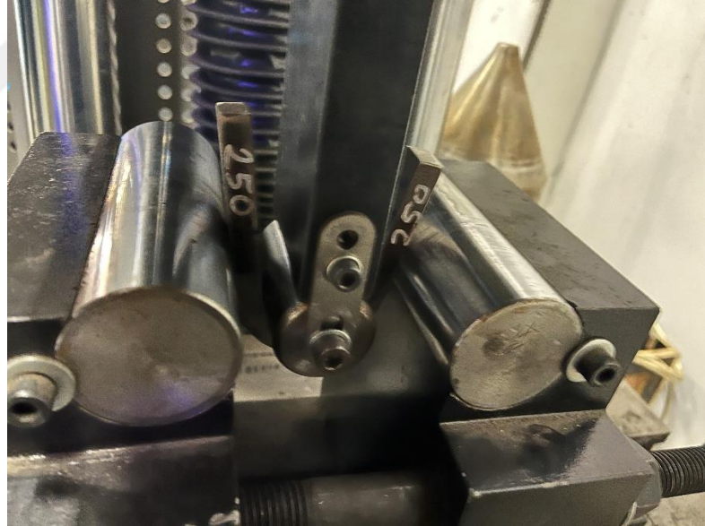
Şekil 4. 58 250°C ön ısı uygulanan kaynaklı numuneden enine kesit alınarak yapılan yan eğme deneyi görüntüsü
