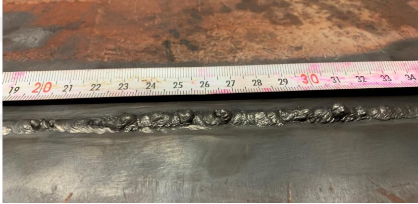
Şekil 4. 14 250°C ön ısı uygulaması ile kaynak yapılan test numunesinin 190-340mm arası kök bölgesi
