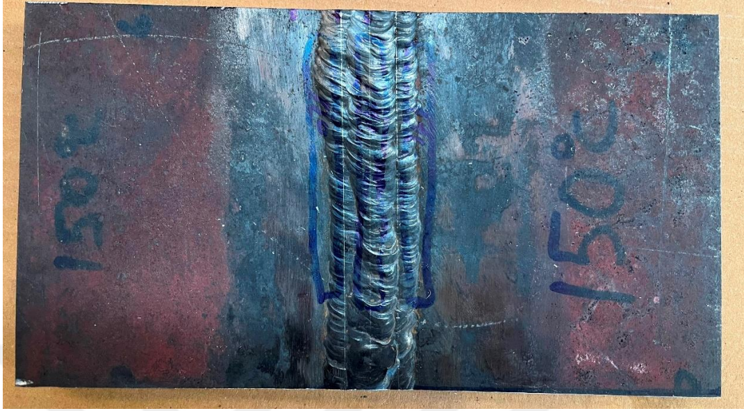
Şekil 4. 62 150°C ön ısı uygulanan kaynaklı plakada çekme çubuğu çıkartılması amacıyla şerit testerede kesilmesi için çizilen çizgiler görülmektedir
