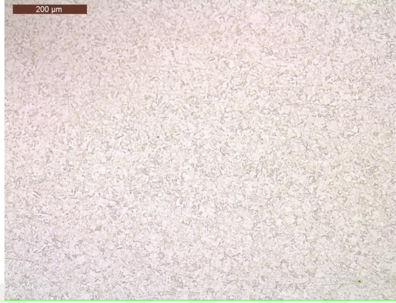
Şekil 4. 54 250°C ön ısı uygulanan kaynaklı plakanın 10X büyütme altında ana malzeme mikroyapı görüntüsü
