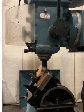
Şekil 3. 2 Kaynak ağzlarının EUMEGA freze ile açılması işlemi sırasında çekilmiş fotoğraf
