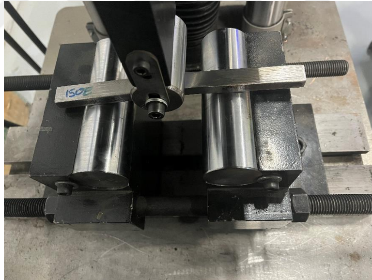
Şekil 4. 56 150°C ön ısı uygulanan kaynaklı numuneden enine kesit alınarak yapılan yan eğme deneyi görüntüsü
