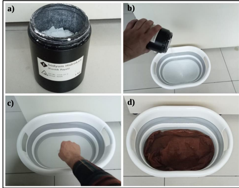
Şekil 3.8: Kullanılan NaOH (a), %10 NaOH çözeltisi (b), %10 NaOH çözeltisi karışımı (c), 4 saat jüt kumaş çözeltide bekledi (d).
