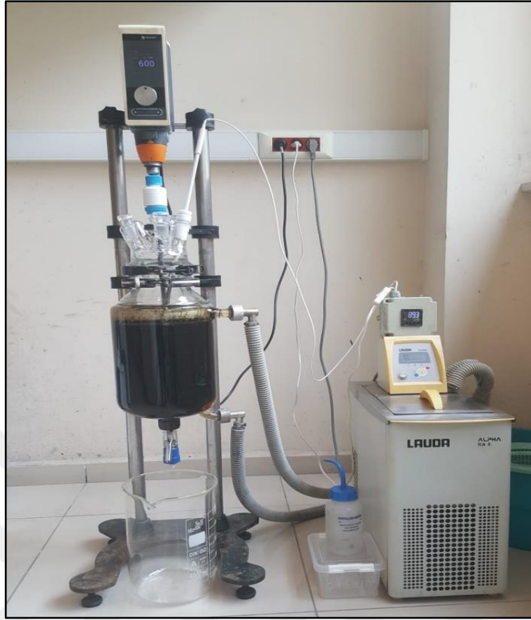
Şekil 3.4: Reaktörde azot katkılı indirgenmiş grafen oksit (NrGO) işleminin görüntüsü.
