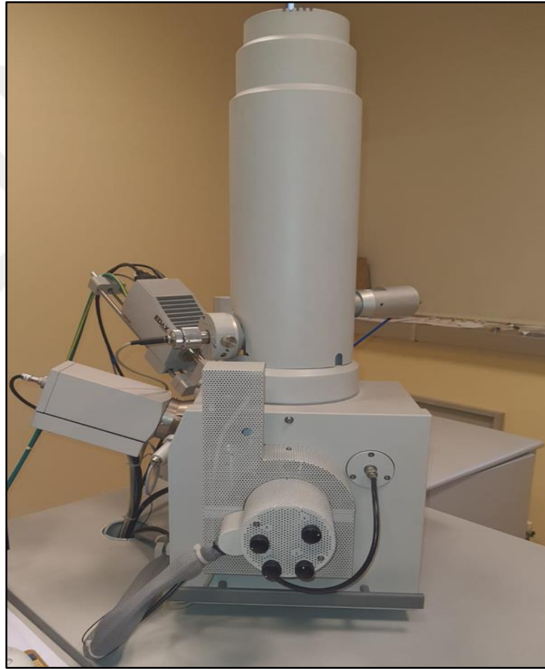
Şekil 4.8: FEI (PHILIPS) XL30 SFEG taramalı elektron mikroskobu.
