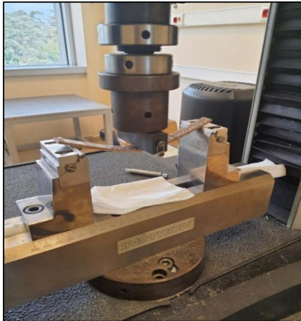
Şekil 4.7: Üç nokta eğme test düzeneği.
