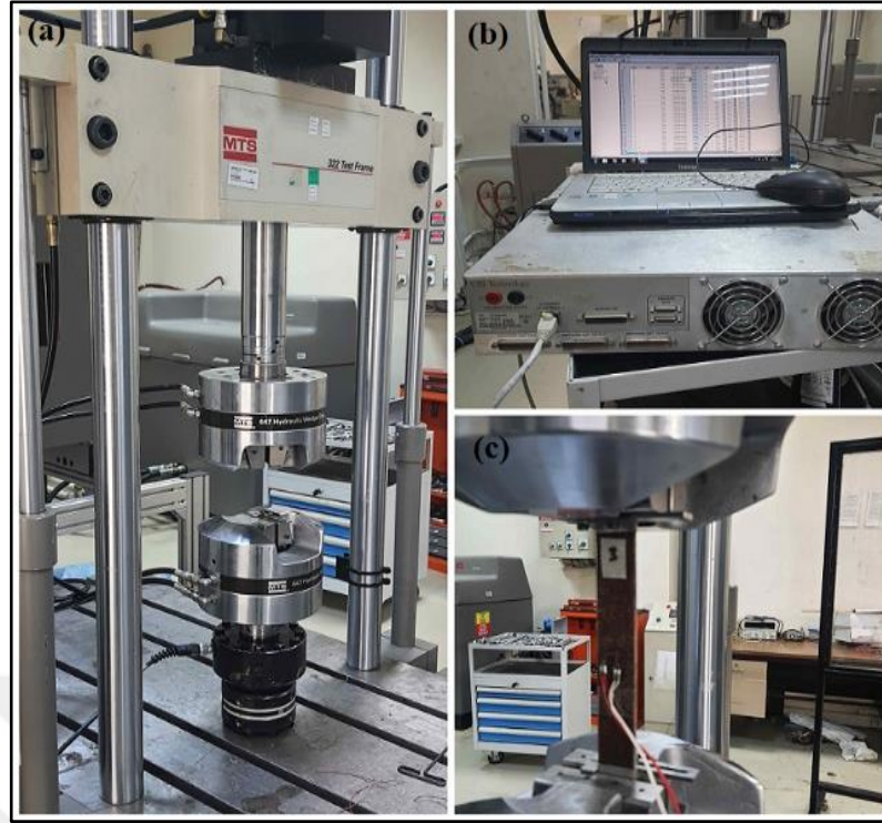
Şekil 4.3: MTS 322 Universal çekme test cihazı (a), Yüksek hızda veri toplama sistemi (b), JF/EP + NaOH 10% numunesi çekme testi anında görüntüsü (c).
