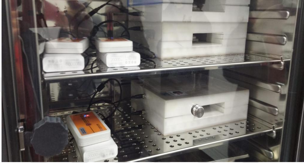
Şekil 12. Osilatörler, güç kaynakları, manyetik alan kutuları ve içlerindeki plakalar etüv içerisinde görülmekte
