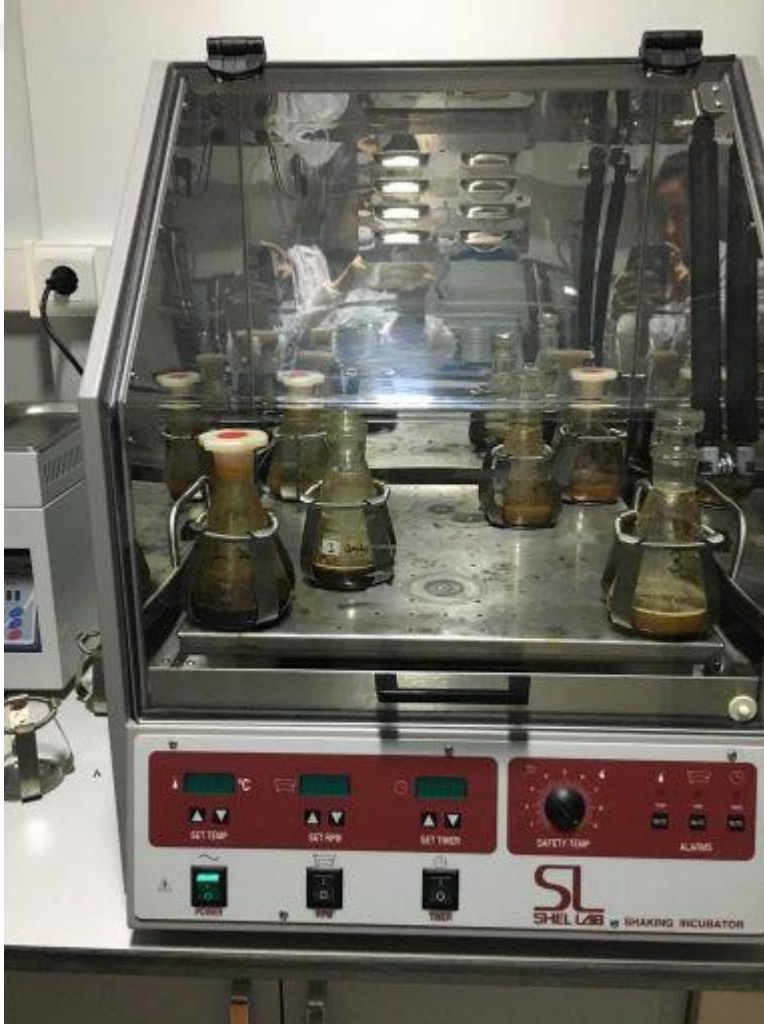
Şekil 6. Propolislerin ekstraksiyon aşamasında kullanılan karıştırma sistemi.
