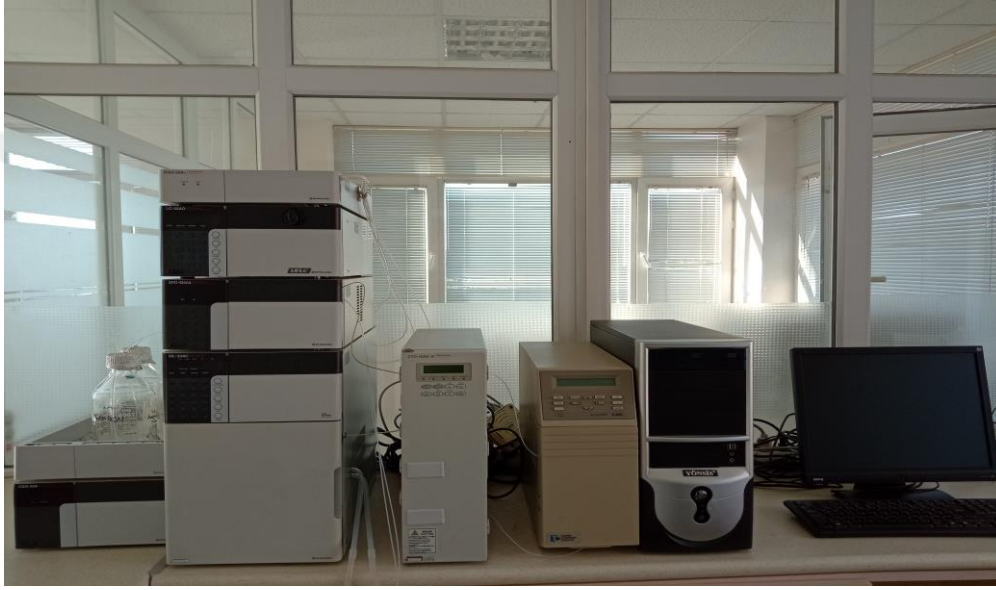
Şekil 11. Propolislerde fenolik bileşiklerin analizlerinin yapıldığı HPLC sistemi.
