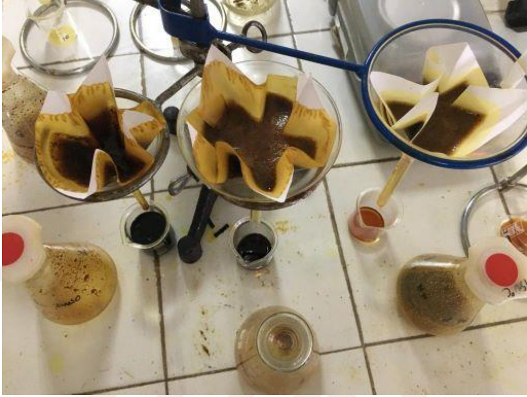
Şekil 7. Propolislerin ekstraksiyon aşamasında filtrasyon işlemleri.
