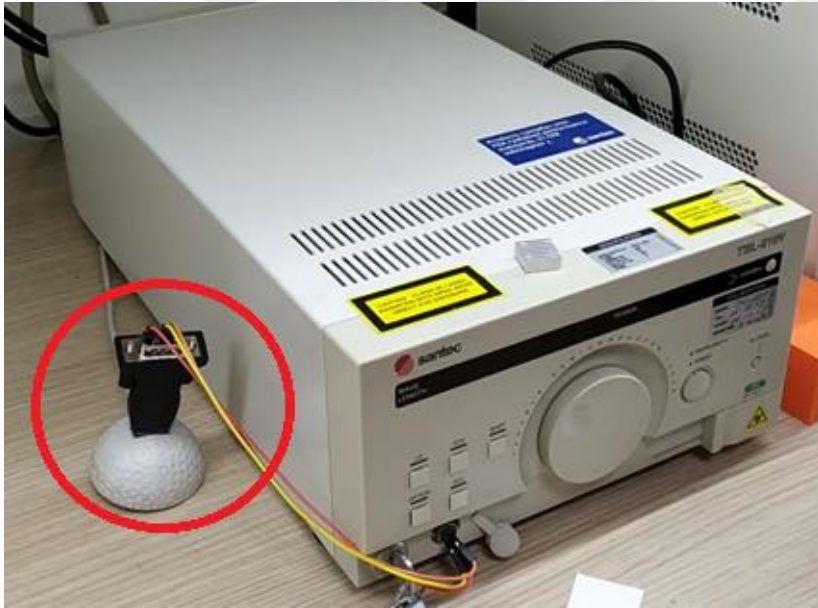
Şekil 5.11. TLS cihazının RS-232 -USB dönüştürücü ile seri bağlantısı
