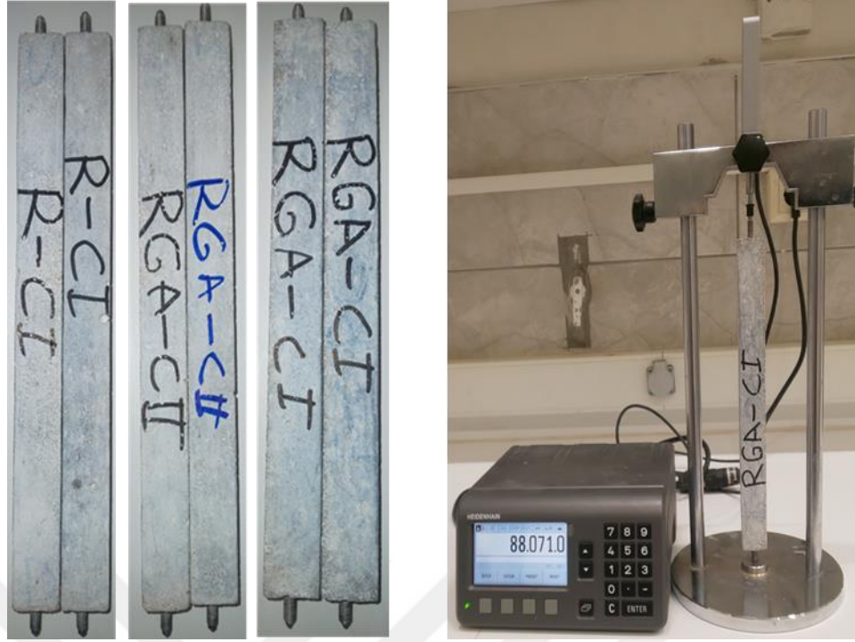
Şekil 30. ASR deneyi için harç çubuğu numuneleri ve dijital komparatör ile ölçümü
