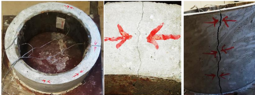
Şekil 58. C-RGA-CII karışımları çatlak şekli
