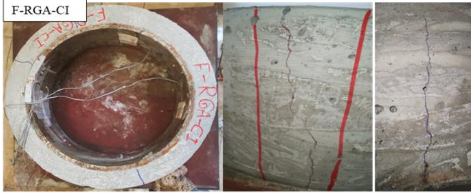
Şekil 55. F-RGA-CI karışımın çatlak şekilleri
