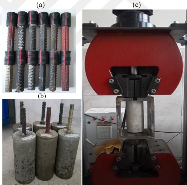
Şekil 36. (a) Pull out numuneleri için hazırlanmış donatılar (b) Üretilmiş pull out testi numuneleri ve (c) Pull out testi düzeneği
