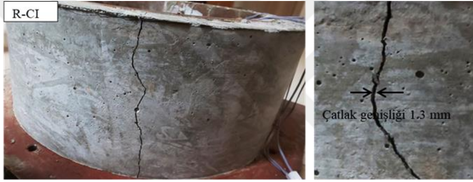
Şekil 53. R-CI karışımının çatlak şekilleri
