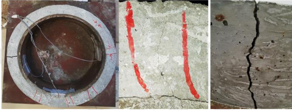
Şekil 56. F+C-RGA-CI karışımın çatlak şekilleri
