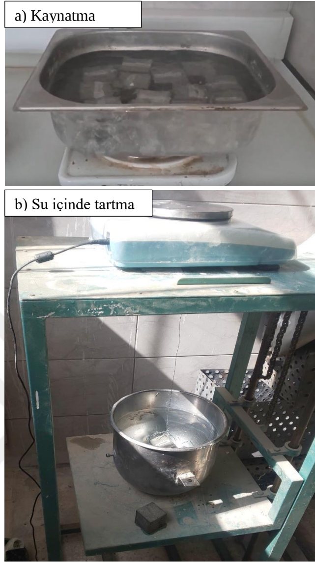
Şekil 38. a) Numunelerin suda kaynatılması b) Numunelerin sudaki ağırlığının belirlenmesi
