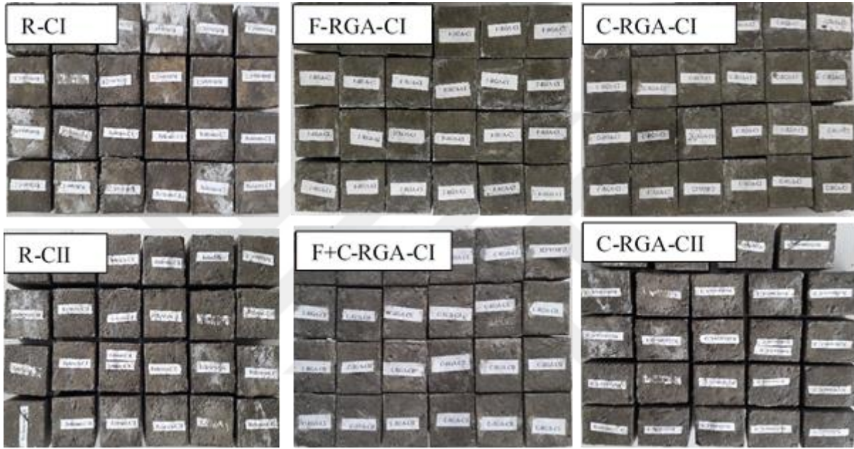
Şekil 34. 50x50x50 mm boyutlarda basınç dayanımı için üretilen numuneler
