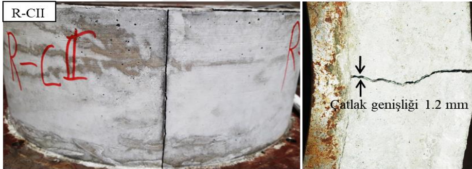
Şekil 56. F+C-RGA-CI karışımın çatlak şekilleri
