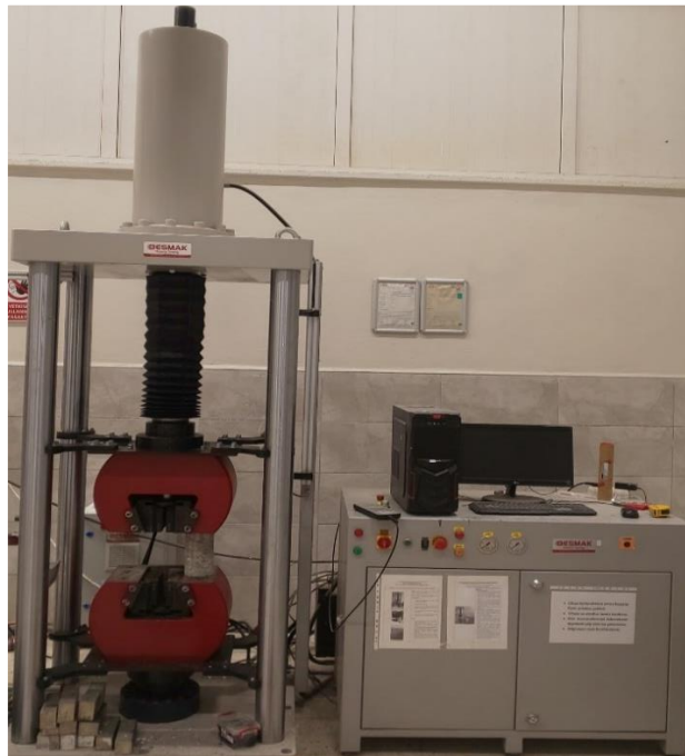
Şekil 21. Aderans dayanımı testi için kullanılan donatı çekme deneyi test cihazı
