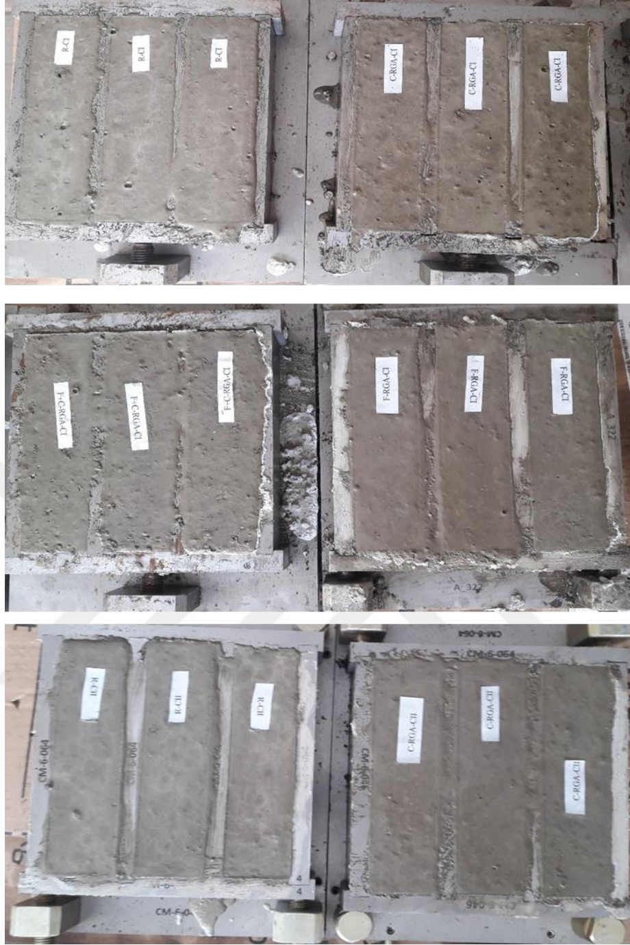
Şekil 35. 40x40x160 mm boyutlarda eğilme dayanımı için üretilen numuneler
