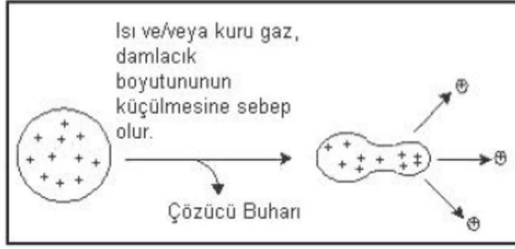
Şekil 4.4 Yüklü damlacıktan çözücünün buharlaşması sonucu oluşan iyon fişkırması [76]
