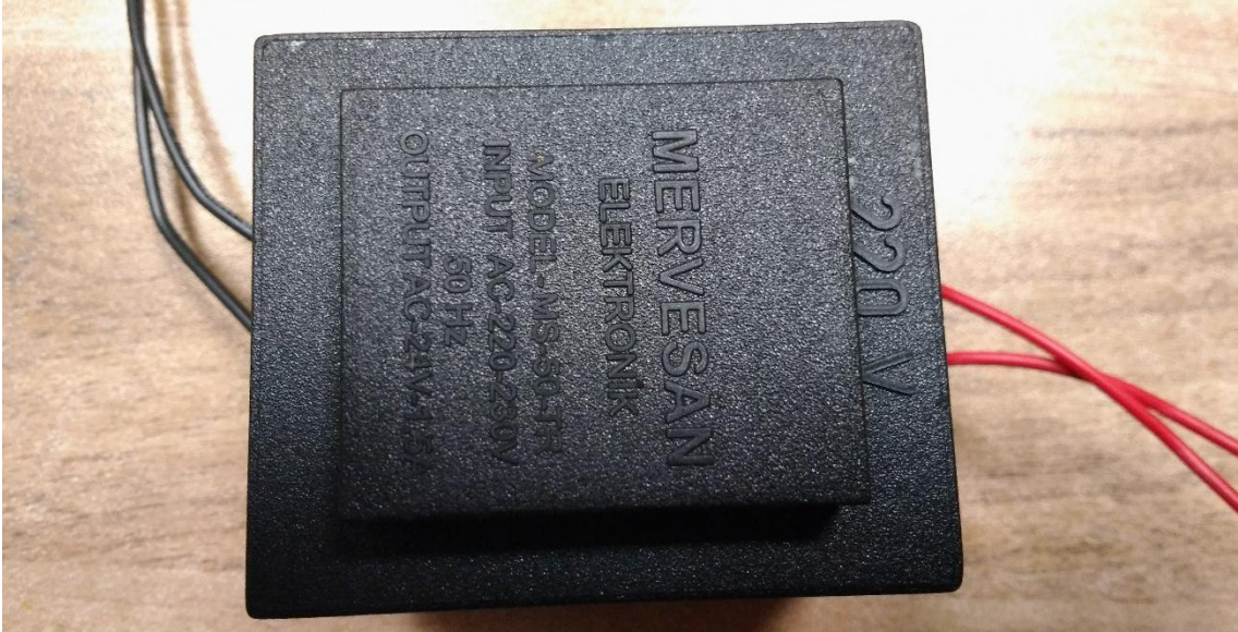
Şekil 5.7 Kapalı tip alçaltıcı gerilim trafosu
