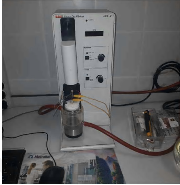
Şekil 4.5. Üçlü elektrot sisteminden oluşan elektrokimyasal hücre
