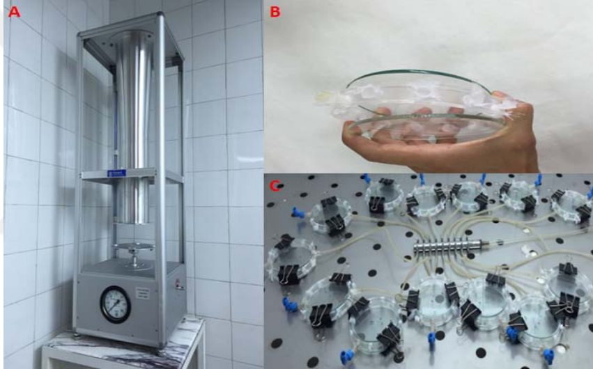
Şekil 3. 9. İlaçlama kulesi (A), pleksi-glass dairesel hücreler ve bu hücreyi ilaçlı yüzeyler karşılıklı gelecek şekilde kapatan camlar (B) deneme üniteleri (C).
