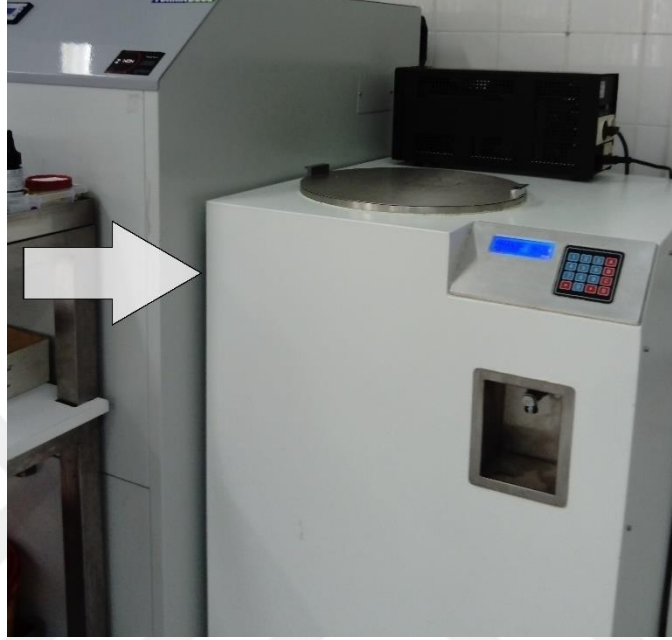
Şekil 2.5. Atık formalin çözeltisinin giderim tankı
