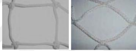
Şekil 1.6 Düğümlü ve düğümsüz ağ materyali (Dikel, 2005)
