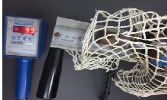
Şekil 2.6 Balık ağlarında mukavemet testleri (Kişisel arşiv, 2018)
