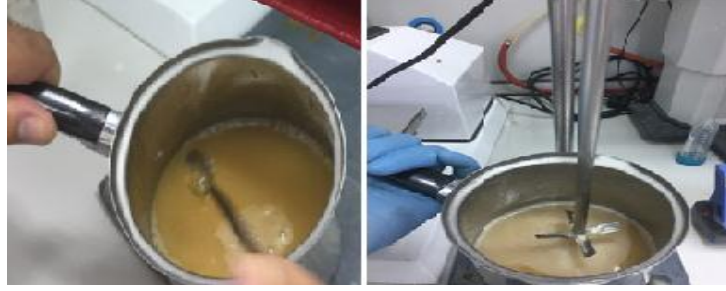
Şekil 2.1 Antifouling Boya-C' nin hazırlanması (Kişisel arşiv, 2018)
