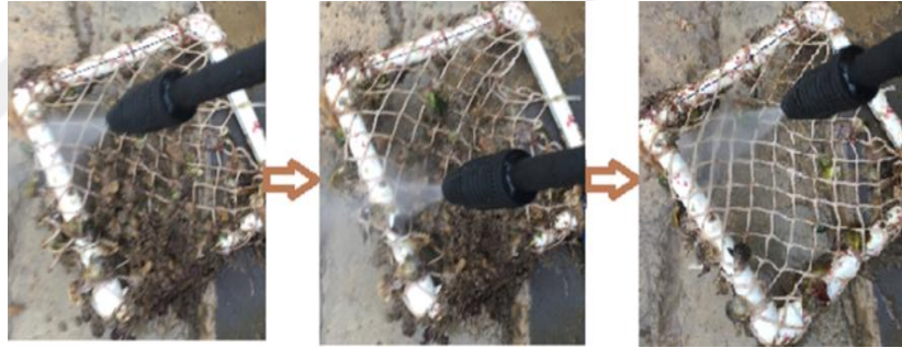
Şekil 2.12 Ağlardaki kirlenmenin su-jet basıncı aparatı ile temizlenmesi (Kişisel arşiv, 2018)
