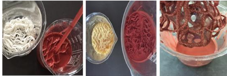
Şekil 2.7 Balık ağlarının antifouling boyalar ile boyanması (Kişisel arşiv, 2018)
