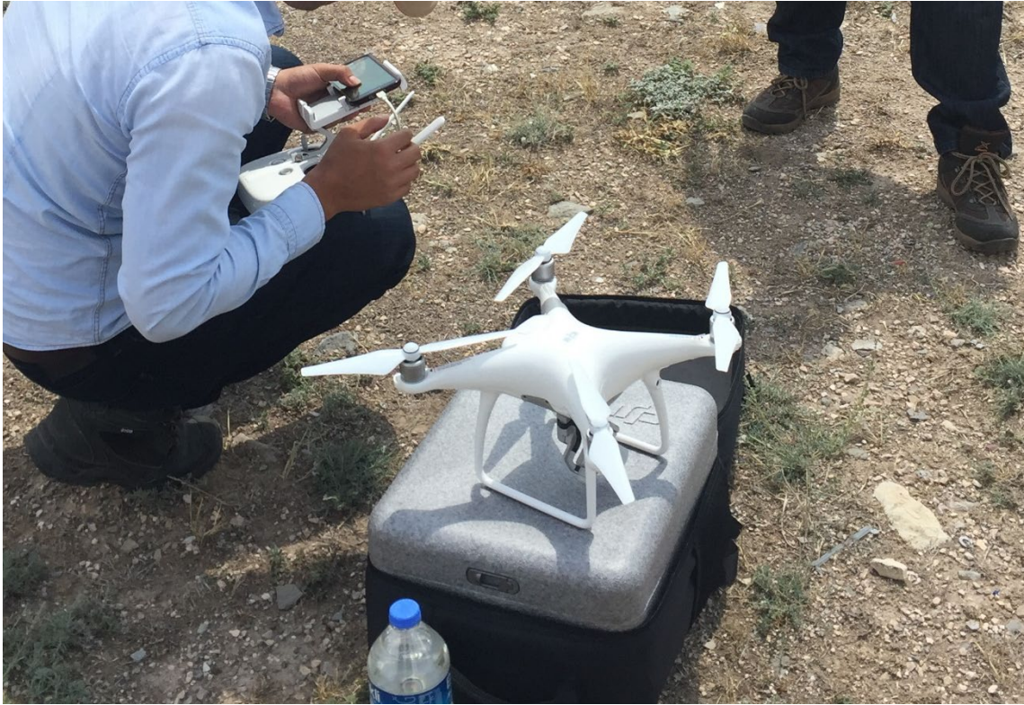
Şekil 2.4. İnsansız Hava Aracı (DJI Phantom 4 Pro).
