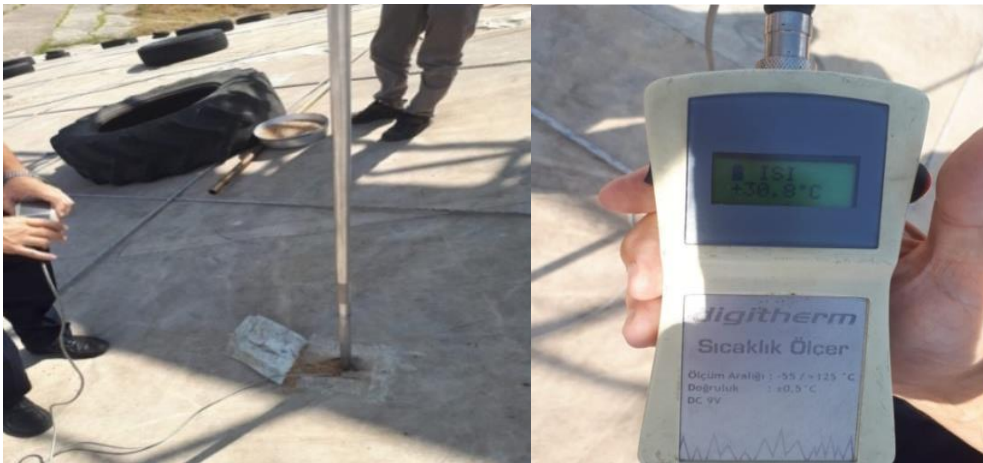
Şekil 3.2. MAYDÜ'de buğday örneği alınan yerlerde yapılan sıcaklık ölçümleri
