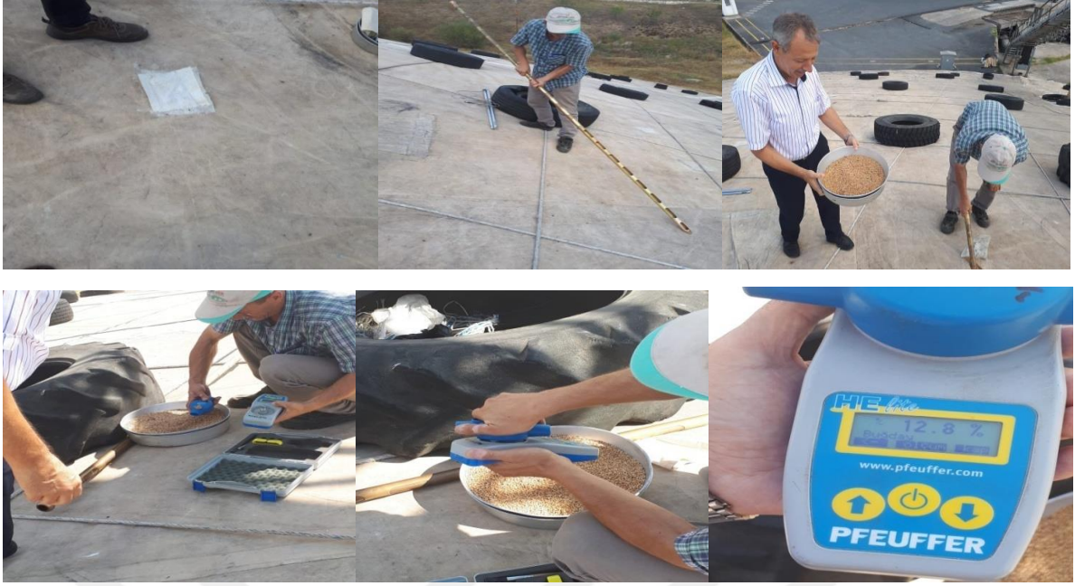
Şekil 3.3. MAYDÜ'de buğday numunesi alımı ve nem içeriğinin ölçümü
