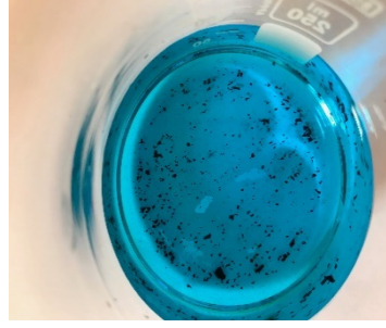
Şekil 4.16: %60 kitosan- %40 polivinilalkol filminin 7 saat salım analizi sonundaki görüntüsü.
