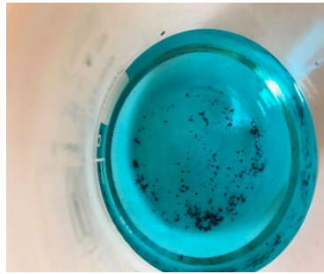
Şekil 4.14: %20 kitosan- %80 polivinilalkol filminin 7 saat salım analizi sonundaki görüntüsü.
