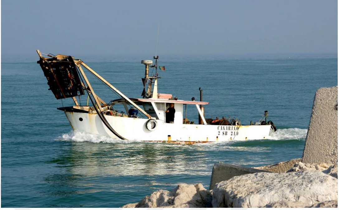
Şekil 3.2. İtalyan tipi kum midyesi avlama teknesinde dreç konumu (Anonim, 2018d)
