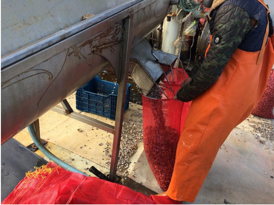
Şekil 2.4.9. Elek sisteminden geçirilen midyelerin torbalara doldurulması (Orijinal)
