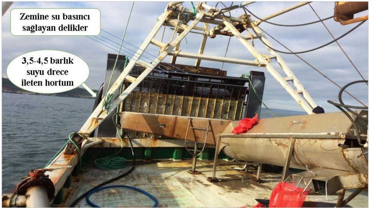
Şekil 2.4.4. Hidrolik drece su giriş ve çıkışı (Orijinal)
