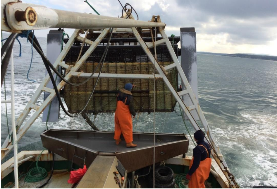
Şekil 2.4.3. Ülkemizde beyaz kum midyesi avcılığında kullanılan hidrolik dreç (Orijinal)
