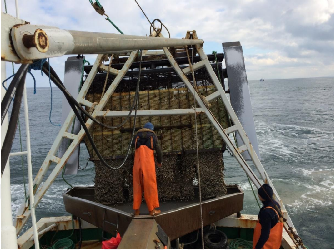
Şekil 2.4.6. Hidrolik dreç ile avlanan midyelerin teknenin kış bölümünde bulunan havuza aktarılması (Orijinal)
