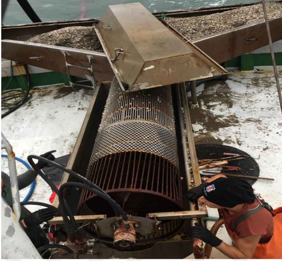
Şekil 2.4.8. Kum midyelerinin ayrıldığı elek sistemi (Orijinal)
