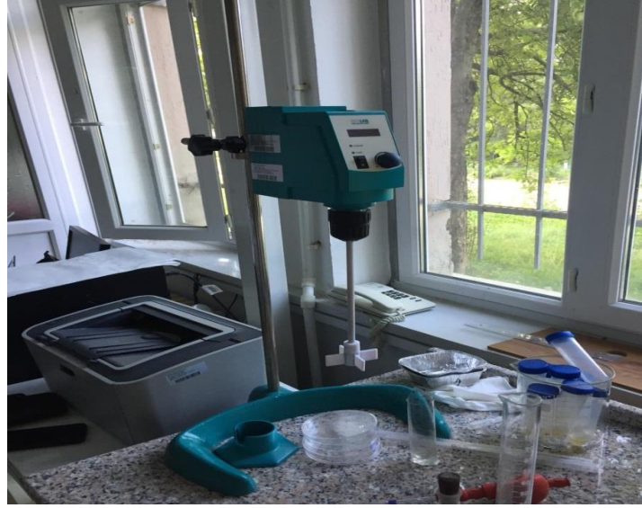
Şekil 4.3. Laboratuvar tipi mekanik karıştırıcı
