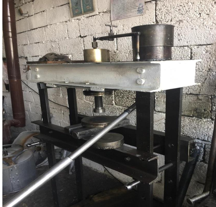
Şekil 4.4. Sanayi tipi manuel hidrolik pres
