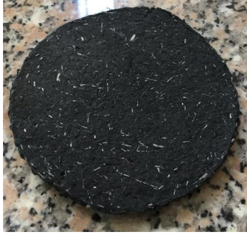
Şekil 4.12. Deri artıklarından ve lavanta sapından yapılan kompozitler (DLK)
