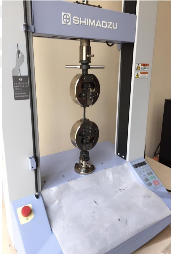
Şekil 4.5. Çekme testi cihazı
