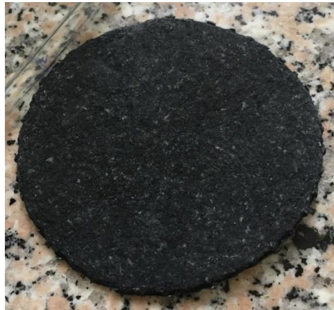
Şekil 4.11. Sadece deri artıklarından yapılan kompozit levhalar (DK)
