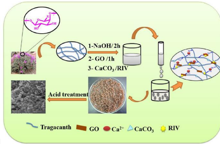
Şekil 2.1. GT-bazlı hidrojellerin sentezi için şematik gösterim [38]
