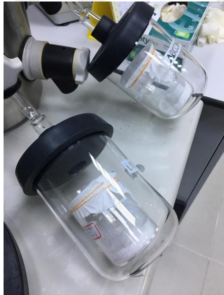
Şekil 3.5. Liyofilizasyon tekniği ile kurutulan numuneler.
