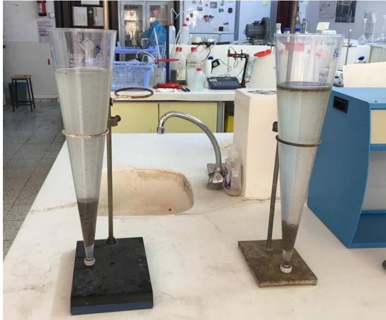
Şekil 4.10. En iyi KOİ giderim verimlerinin elde edildiği şartlarda 1000 mL numune hacminde imhoff hunisinde çökelme işlemi (a) başlangıç aşaması, (b) 30 dakika sonunda çökmüş çamur
