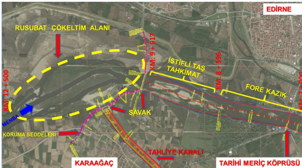
Şekil 5.18 : Meriç nehri yatak temizliği ve tahkimatı inşaatı (Devlet Su İşleri 11.Bölge Müdürlüğü, 2019).
