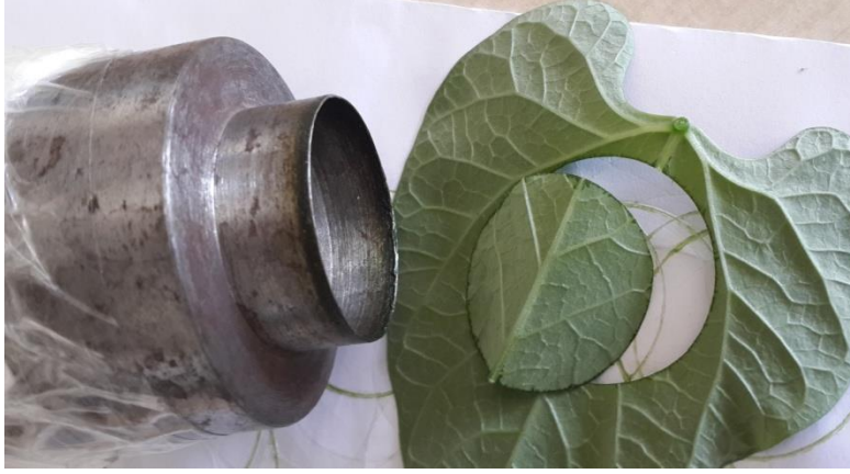
Şekil 3. 7. Yaprak disklerinin çıkarılması
