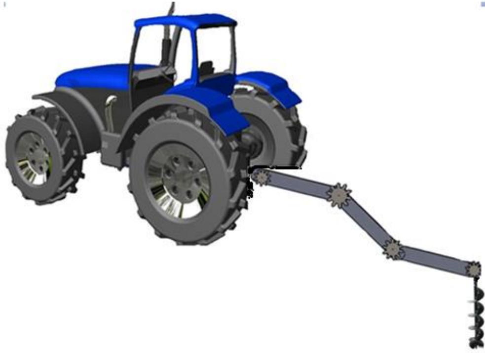
Şekil 5.1. Söz konusu tasarıma toprak burgu aparatının monte edilmesi
