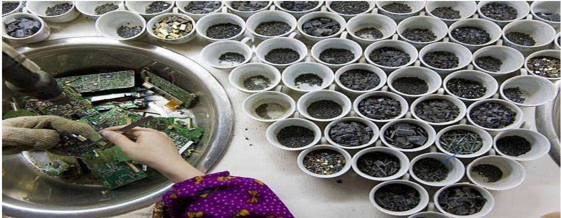
Şekil 5.10 E-Atıkların el ile mekanik olarak ayrılması esnasında ayrılan metal, plastik ve çipler (Kahraman, 2014)
