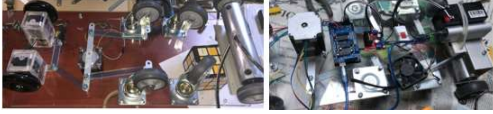
Şekil 2.3.2. İlk prototipte arka sıra tekerleklerin iptal edilip DC motorların eklenmesi
