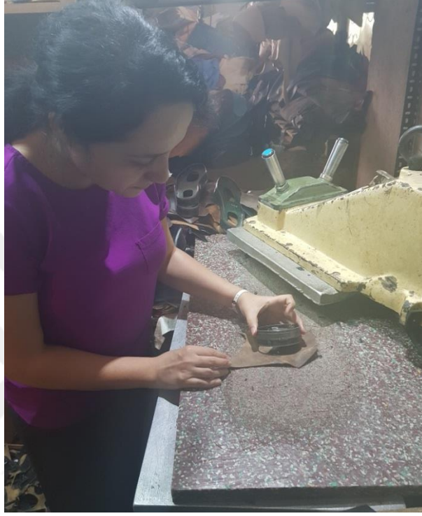
Şekil 35. Motifi Prese Hazırlama
