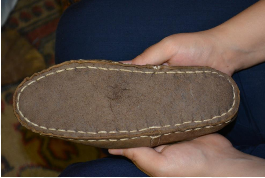
Şekil 54. Çarığın Alt Dikişinin Bitmiş Hali ve Alttan Görünüşü
