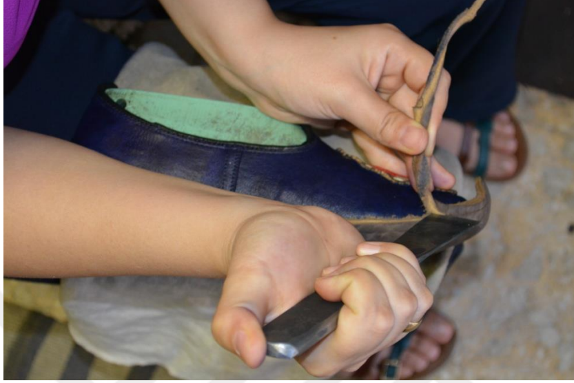
Şekil 62.Çarığın Tabanındaki Fazlalıkları Kesme
