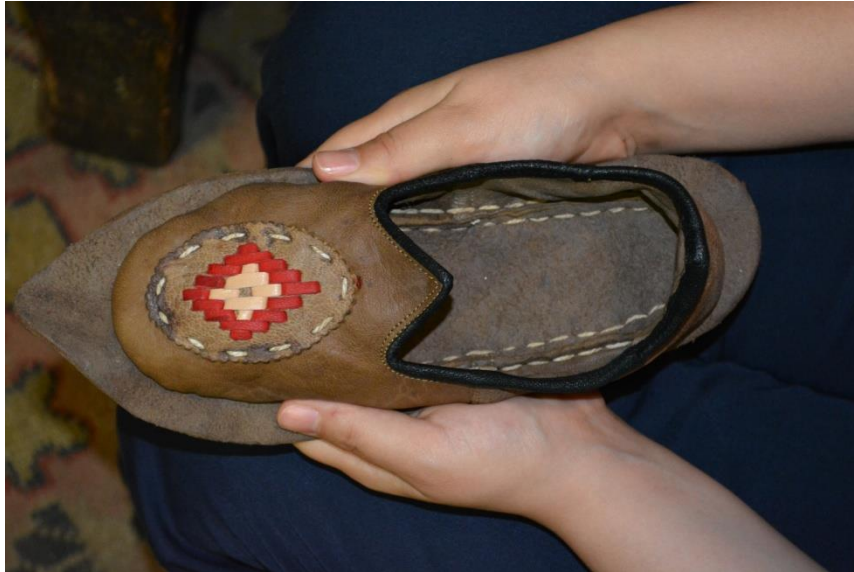
Şekil 55. Çarığın Alt Dikişinin Bitmiş Hali ve Alttan Görünüşü
