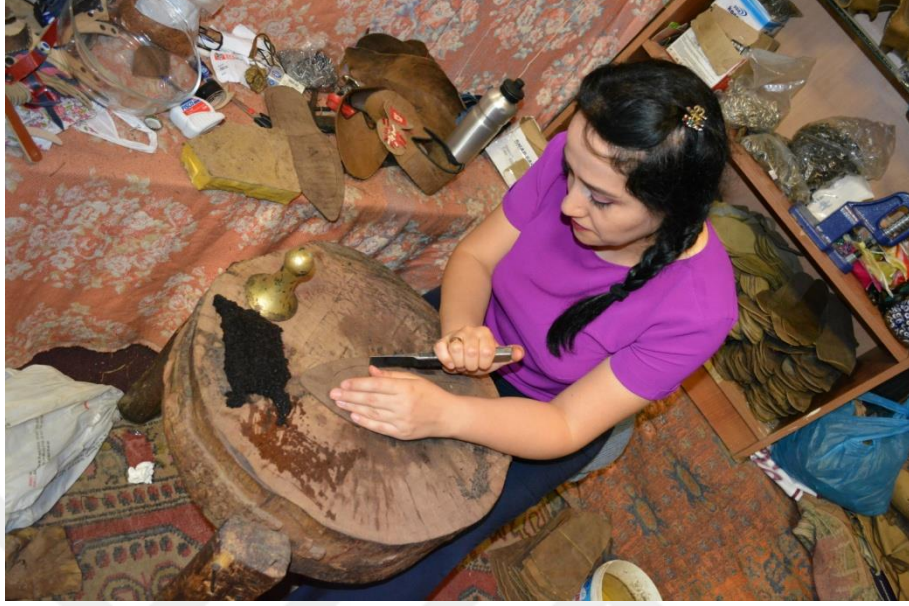
Şekil 33. Çarığın Tabanını Kesme
