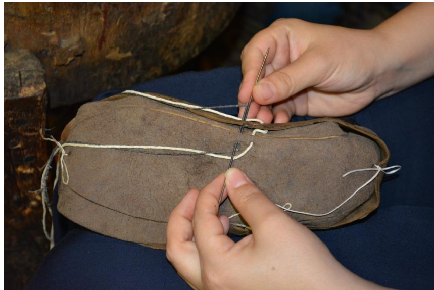
Şekil 51.Çarığı Çatmanın İkinci Kısımı
