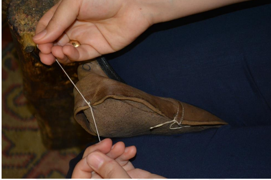
Şekil 50. Çarığı çatmanın ilk kısmı
