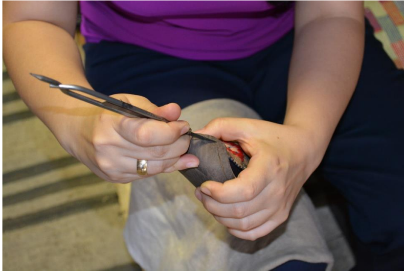
Şekil 61. Çarığın Alt Tabanının Deri Bıçağı İle Fazlalığını Kesme
