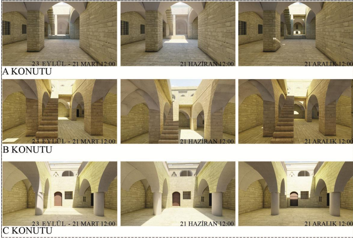
Şekil 4.28. A, B ve C konutlarında güneş ışığının alt katlara taşınması simülasyonu
