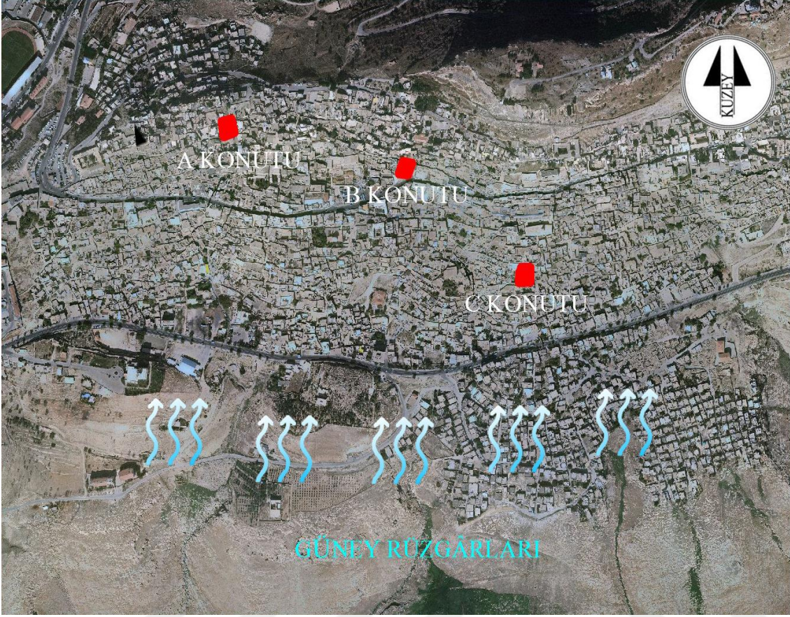
Şekil 4.30. A, B ve C konutlarında bina yerleşimi ve oryantasyonu ile rüzgârdan faydalanma
