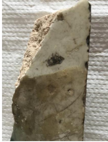
Resim 6.2.b. Alkol ile temizlik
