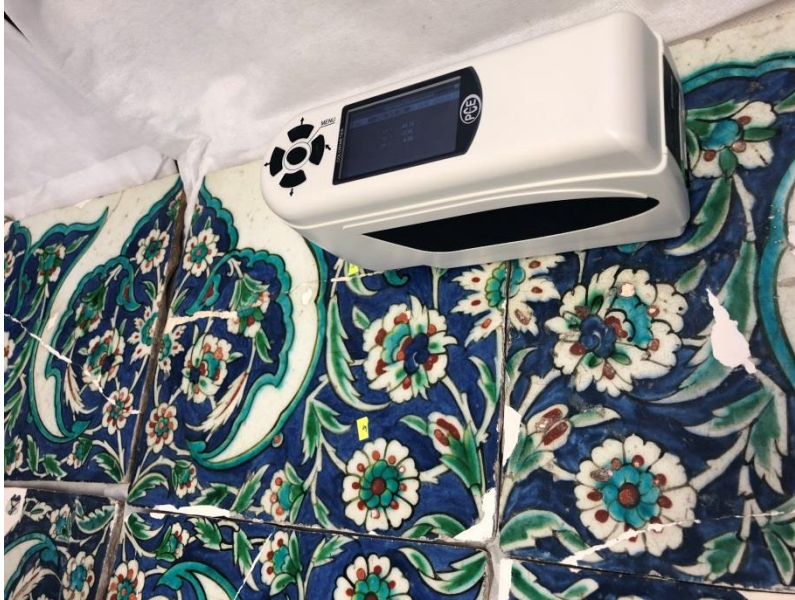
Resim 5.63. Renk analizi uygulama
