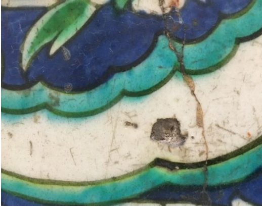
Resim 5.17. Çizik, kılcal çatlak ve aşınma
