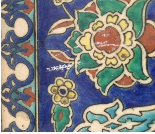
Resim 5.46. Sarı çiçek üstünde sır patlaması, beyaz leke Resim 5.47. Çatlak
