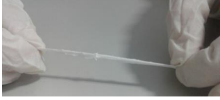
Şekil III.37 %10'luk PCL'in 2 mm'lik Kollektördeki Boru İskelesi
