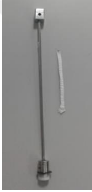
Şekil III.30 %12'lik PLA'nın 3 mm'lik Kollektördeki Boru İskelesi
