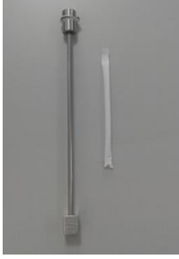
Şekil III.31 %12'lik PLA'nın 4 mm'lik Kollektördeki Boru İskelesi
