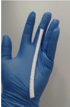
Şekil III.44 %12'lik PCL'in 5 mm'lik Kollektördeki Boru İskelesi
