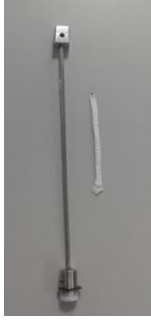
Şekil III.42 %12'lik PCL'in 3 mm'lik Kollektördeki Boru İskelesi
