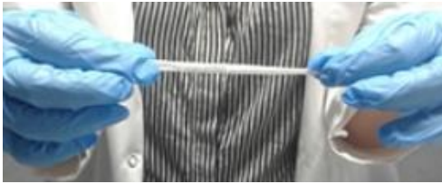
Şekil III.35 %8'lik PCL'in 4 mm'lik Kollektördeki Boru İskelesi
