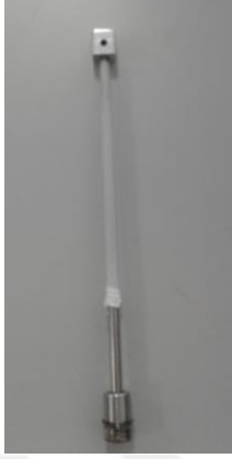
Şekil III.27 %10'luk PLA'nın 4 mm'lik Kollektördeki Boru İskelesi
