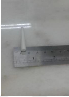
Şekil III.43 %12'lik PCL'in 4 mm'lik Kollektördeki Boru İskelesi
