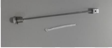
Şekil III.34 %8'lik PCL'in 3 mm'lik Kollektördeki Boru İskelesi
