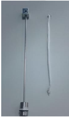
Şekil III.25 %10'luk PLA'nın 2 mm'lik Kollektördeki Boru İskelesi
