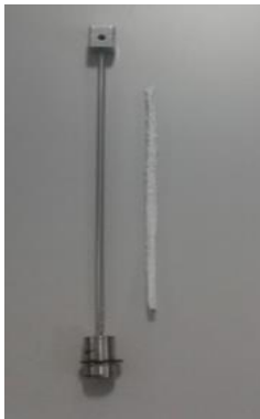
Şekil III.38 %10'luk PCL'in 3 mm'lik Kollektördeki Boru İskelesi
