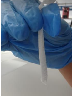
Şekil III.40 %10'luk PCL'in 5 mm'lik Kollektördeki Boru İskelesi
