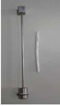
Şekil III.22 %8'lik PLA'nın 3 mm'lik Kollektördeki Boru İskelesi
