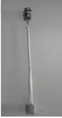
Şekil III.26 %10'luk PLA'nın 3 mm'lik Kollektördeki Boru İskelesi
