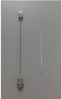
Şekil III.41 %12'lik PCL'in 2 mm'lik Kollektördeki Boru İskelesi
