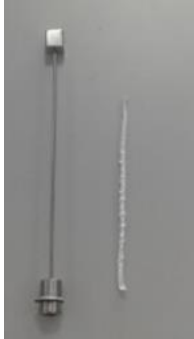
Şekil III.33 %8'lik PCL'in 2 mm'lik Kollektördeki Boru İskelesi
