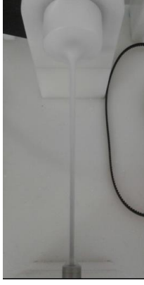
Şekil III.23 %8'lik PLA'nın 4 mm'lik Kollektördeki Boru İskelesi
