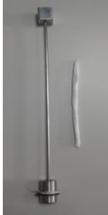
Şekil III.21 %8'lik PLA'nın 2 mm'lik Kollektördeki Boru İskeleti
