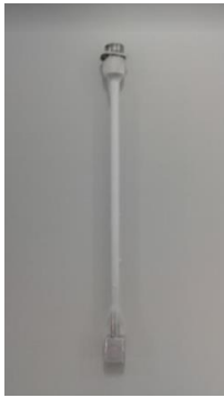
Şekil III.24 %8'lik PLA'nın 5 mm'lik Kollektördeki Boru İskelesi
