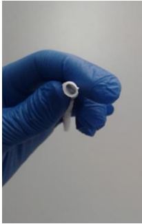
Şekil III.32 %12'lik PLA'nın 5 mm'lik Kollektördeki Boru İskelesi
