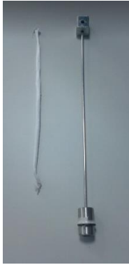
Şekil III.29 %12'lik PLA'nın 2 mm'lik Kollektördeki Boru İskelesi
