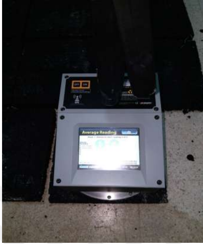
Şekil 4.7. Laboratuvar numuneleri üzerinde PQI ölçümleri.
