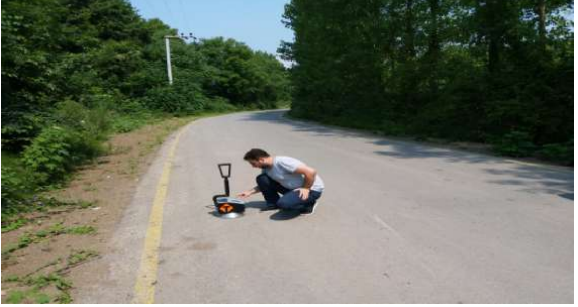
Şekil 4.4. Bataklı yolunda PQI deney aleti ile arazi ölçümleri.
