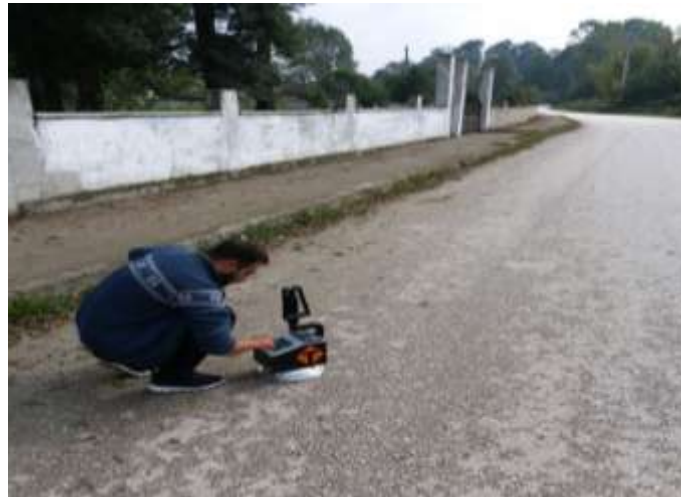
Şekil 4.5. Darıcı yolunda PQI deney aleti ile arazi ölçümleri.
