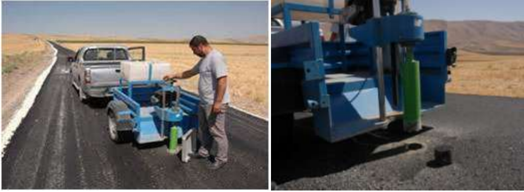
Şekil 2.4. Araziden karot numunesi alma (BİÖ İdaresi, 2012).
