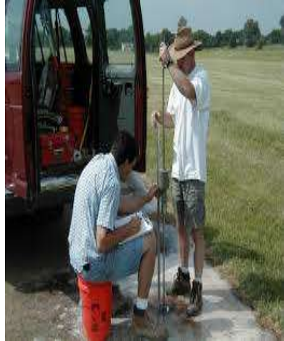
Şekil 2.6. Arazide dinamik koni penetrasyon uygulaması (Z.A. Merkezi, 2004).
