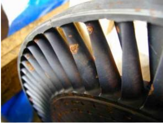
Şekil 2.9. Korozyona uğramış bir buhar türbini (Dave 2015)
