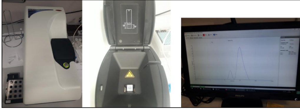
Şekil 2.4. Oluşturulan kitosan nanopartiküllerinin karakterizasyonu (Malvern Zeta-sizer Nano-ZS, Malvern, Inst. Ltd. UK).
