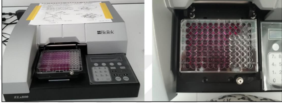
Şekil 2.15. MTT protokolü sonrası hücrelerde oluşan mavi formazan miktarına bağlı absorbans değerlerinin mikropłaka okuyucu spektrofotometrede ölçülmesi (BioTek-ELx800, UK).
