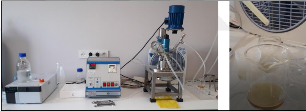
Şekil 2.1. Yüksek basınçlı sıcak su ekstraksiyon cihazı (Amar Equipments, India) ve ekstraksiyon sonrasında elde edilen protein lizatı.
