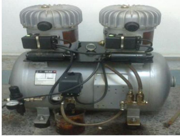
Şekil 3.3. Mikrodalga reaktöre ait hava kompresörü
