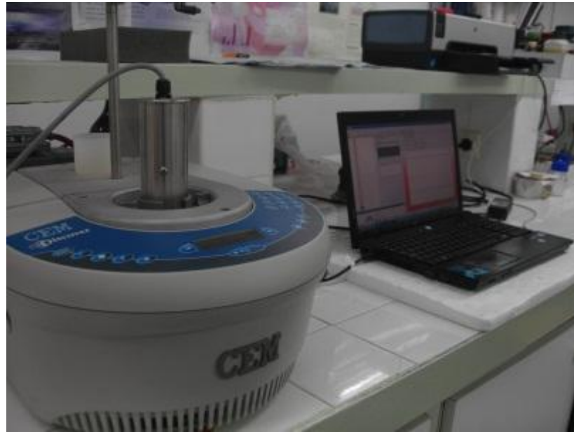
Şekil 3.2. Sentez çalışmalarında kullanılan mikrodalga reaktörü
