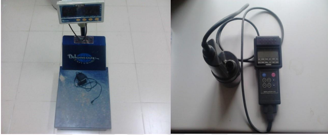
Şekil 3.3. Denemede kullanılan ekipmanlar a) Terazi, b) Su elektriksel iletkenliği ölçme aleti (EC metre)
