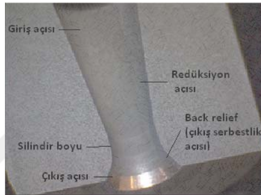
Şekil 1.6.1. Hadde Kesit Görüntüsü ve Hadde Bölgeleri [25]
