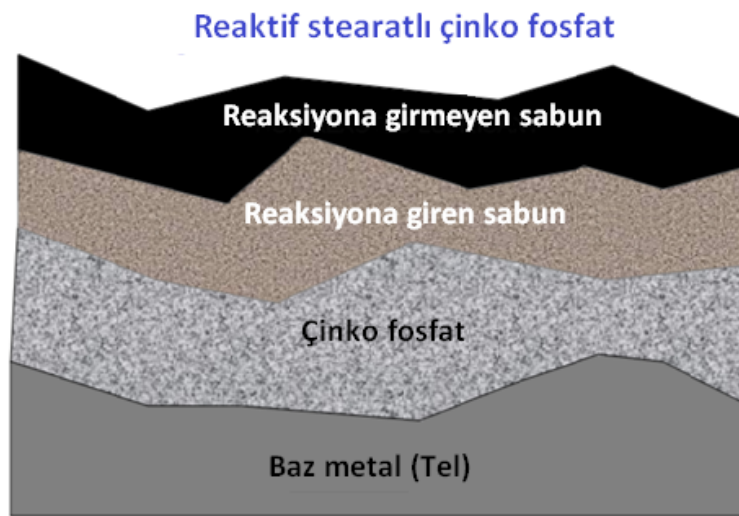
Şekil 1.7.2. Tel Fosfat Kaplama-Yağlayıcı Sabun Etkileşimi [43]
