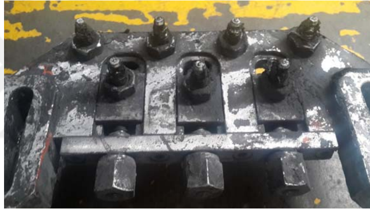
Şekil 1.7.5. Döner Aksamlara Yapışarak Dönme Hareketine Engel Olan Sabun Kalıntıları
