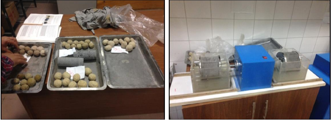
Şekil 3.19. Slake durabilite deneyinin yapılmasında kullanılan numuneler ve ekipman
