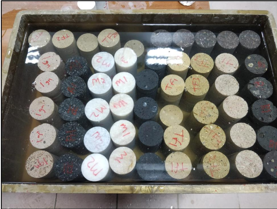
Şekil 3.21. Örneklerin donma çözünme deneyi öncesindeki suya doyurma aşaması
