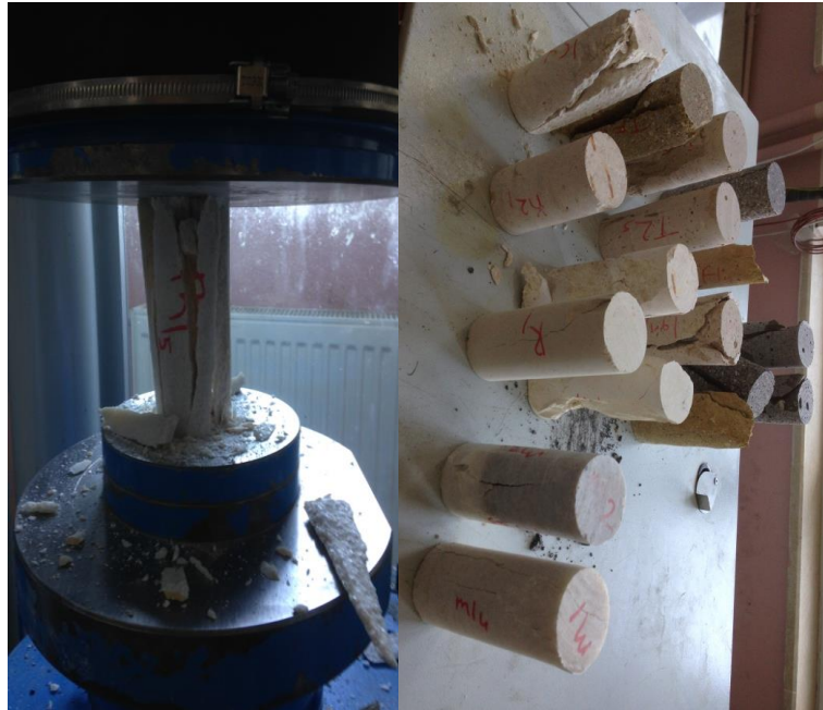
Şekil 3.23. Tek eksenli basınç deneyi aleti ve kırılan numuneden bir görüntü
