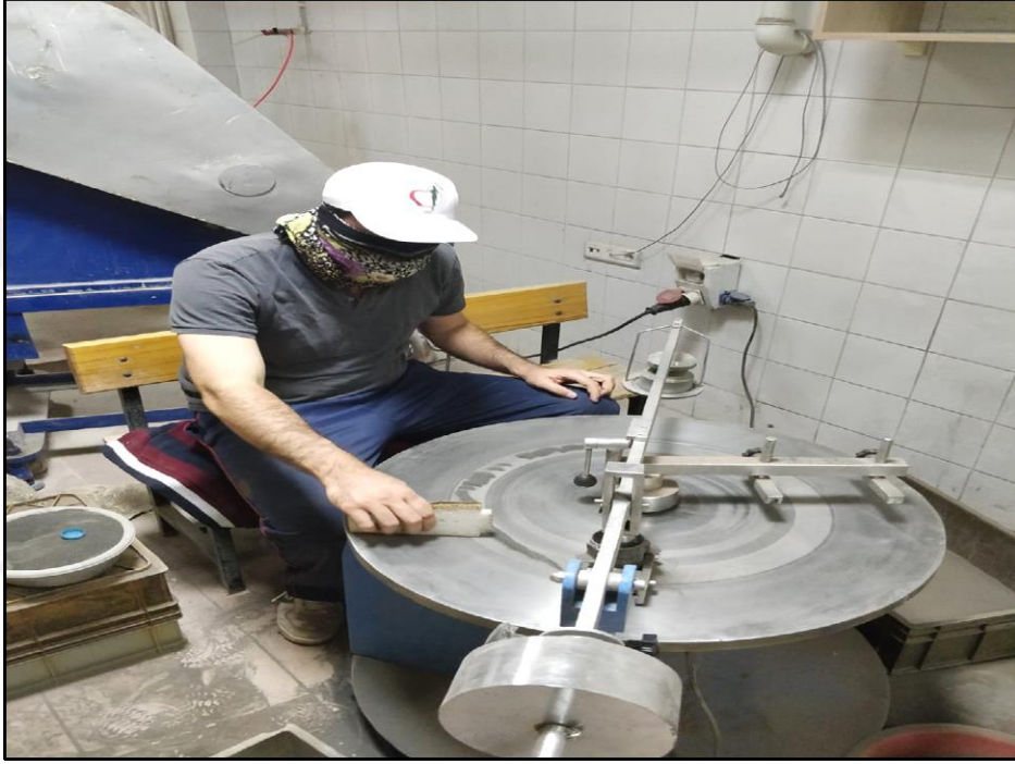
Şekil 3.20. Aşındırma deneyi ekipmanı ve deney yapım aşaması
