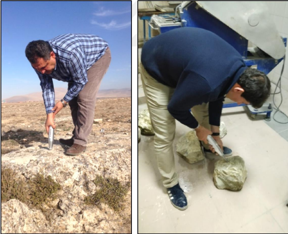
Şekil 3.18. Schmidt çekici ile araziden ve blok numune üzerinden ölçüm alımı
