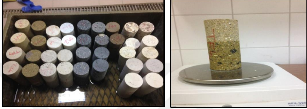
Şekil 3.17. Kılcal su emme deneyinde su emme miktarının belirlenmesi
