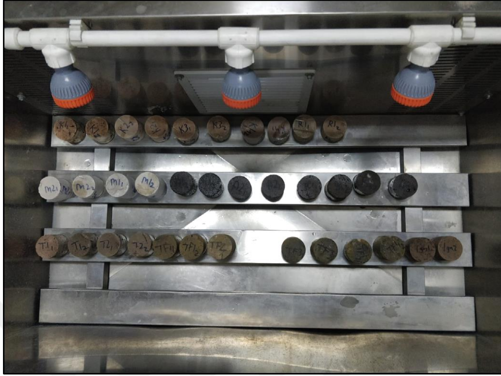
Şekil 3.22. Örneklerin donma çözünme deneyi sonrasındaki görünümü
