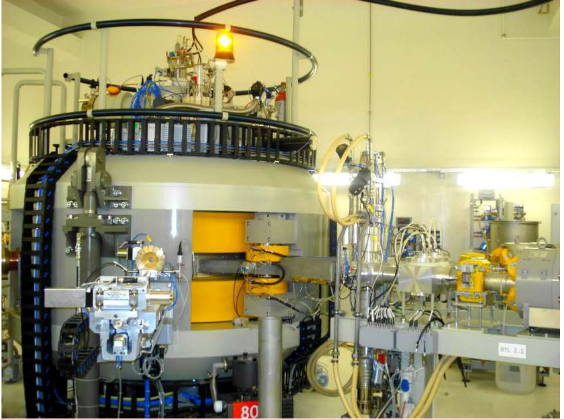
Şekil 2 2 Cyclone 30 Hızlandırıcı Sistemi (TAEK, 2012)
