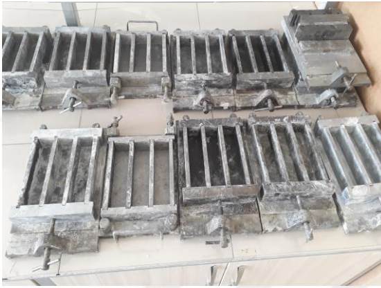
Fotoğraf 4.2. 4x4x16 cm boyutlarındaki kalıp (a) ve harç yerleştirilmiş kalıp (b)
