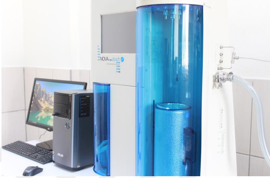
Fotoğraf 3.4. UKÜ yüzey alanı ölçümünü yapan BET cihazı
