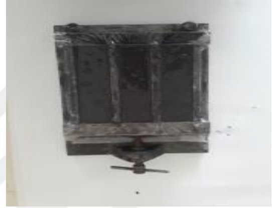
Fotoğraf 4.2. 4x4x16 cm boyutlarındaki kalıp (a) ve harç yerleştirilmiş kalıp (b)
