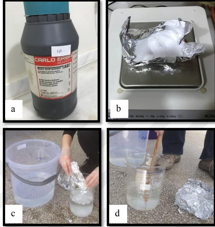
Şekil 3.4 a. Denemede kullanılan borik asit ( H_3BO_3 , %17.5 B), b. Her doz için ayrı ayrı borik asit ( H_3BO_3 ) tartımı, c. Bitkilere uygulanmak üzere bor dozunun ayarlanması, d. Borik asiti suda çözme işlemi
