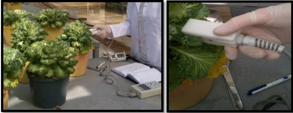
Şekil 3.7 Yapraklardaki stoma iletkenliğinin ölçümü
