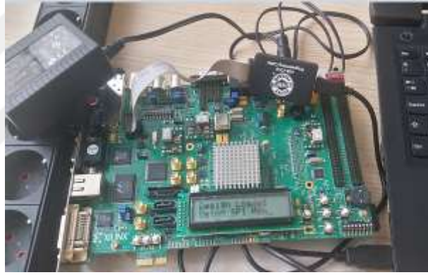
Şekil 3.6. FPGA kartı ile bilgisayar bağlantısı
