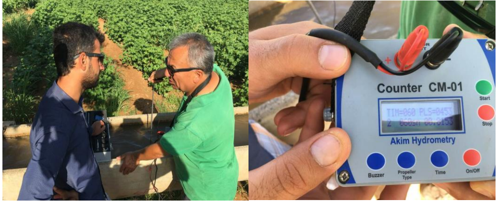
Şekil 3.5. Kanalette akan suyun hızının cüce muline ile ölçümü
