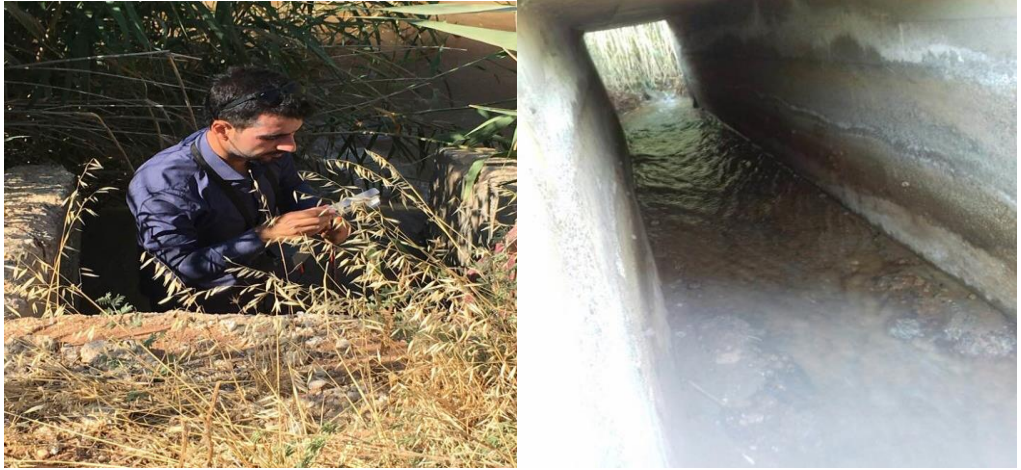
Şekil 3.7. Araştırma alanı yüzey akış sularının hız ölçülmesi
