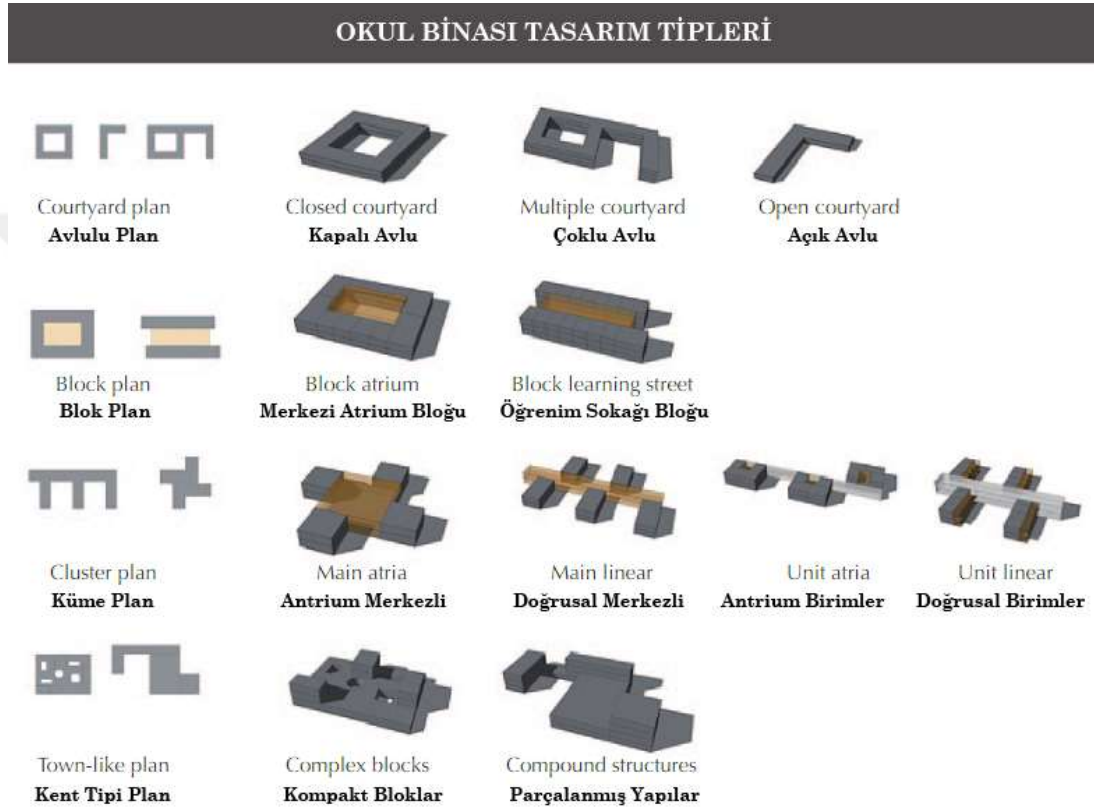
Şekil 3.2 Okul binası tasarım tipleri (Rigolon, 2010)
