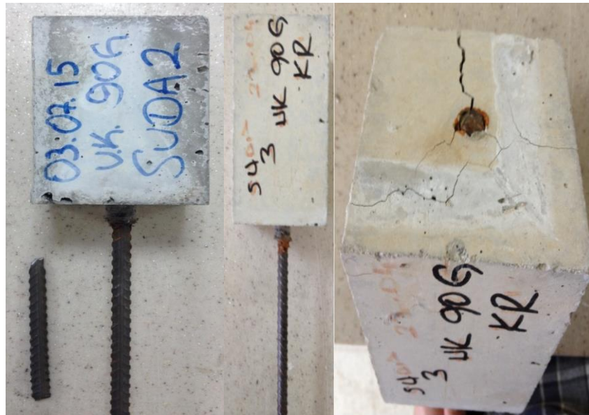
Şekil 3.27. 90 günlük UK su kürü numunesinin kriyojenik işlem öncesi ve sonrasında hasar durumu
