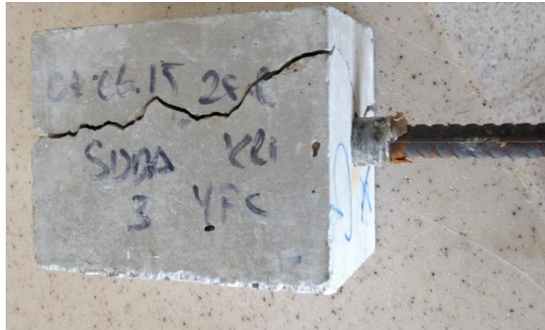
Şekil 3.23. 28 günlük su kürü Kriyojenik-YFC numunesinin aderans deneyi sonrası görünüşü.
