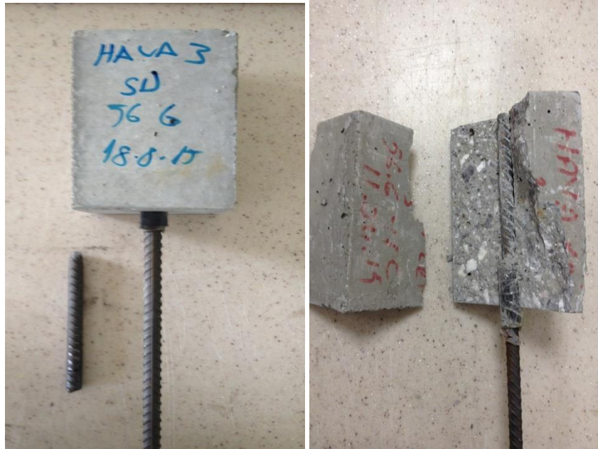
Şekil 3.25. 56 günlük SD hava kürü numunesinin kriyojenik işlem öncesi ve sonrası hasar durumu.
