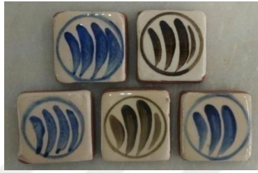
Fotoğraf 138: Endüstriyel astarlı plaka denemeleri. Bu plakalarda da astarda ki kırmızı çamur oranı giderek artmıştır.
