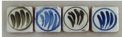
Fotoğraf 135: Kütahya astarlı plaka denemelerinden 1. ve 2. plaka astar boya ile 3. ve 4. plaka çini boyası ile boyanmıştır.
