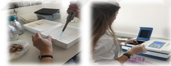
Şekil 3.5 Spektrofotometre cihazı ile silajların SÇK, LA, NH içeriklerinin belirlenmesi
