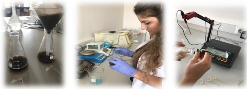
Şekil 3.4 Silajlardan alınan süzüntüde pH ölçümü
